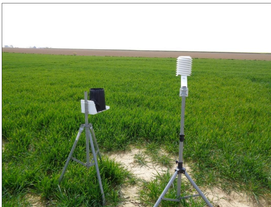
Figure 197 : Enregistreur de température et pluviomètre sur la parcelle de blé tendre d'Anguerny le 15 avril 2019
