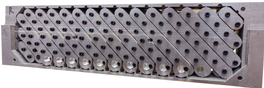
FIGURE 3.18: Pantographe seul, bras non séparés des plaques
