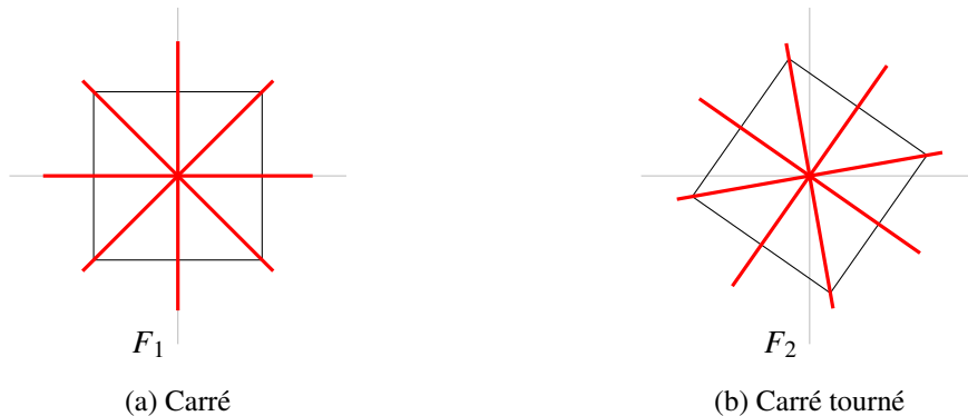
FIGURE 1.16: Influence de l'orientation sur la définition des éléments de symétrie
