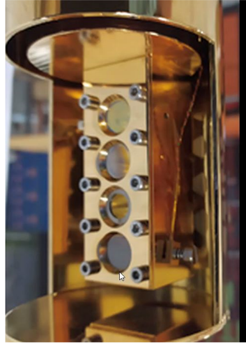
FIGURE 15 – Photo du porte échantillon d'adénine utilisé pour les irradiations à ATOMKI.
