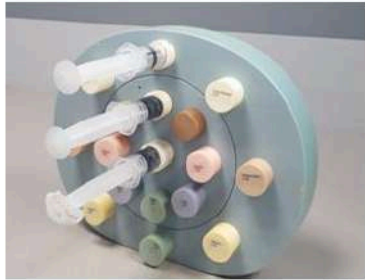
Figure 3 : Photographies du fantôme utilisé dans les expériences des études de répétabilité et reproductibilité
