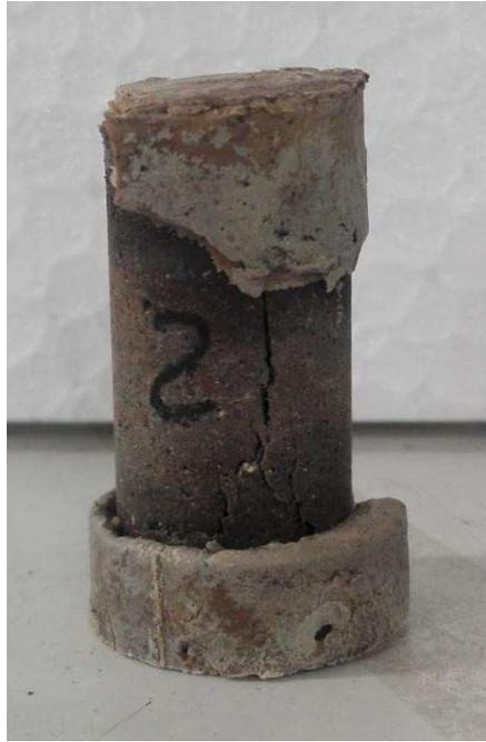
FIGURE 4.5 – Éprouvette de compression du coulis de ciment utilisé pour remplir les inclusions (vue après rupture).
