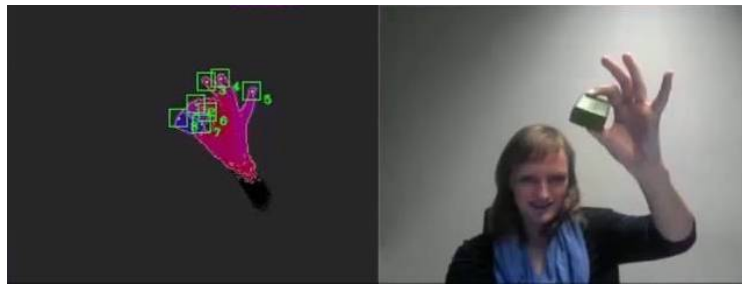
FIGURE 1.4 – Exemple d'estimation de la position de la main [16]
