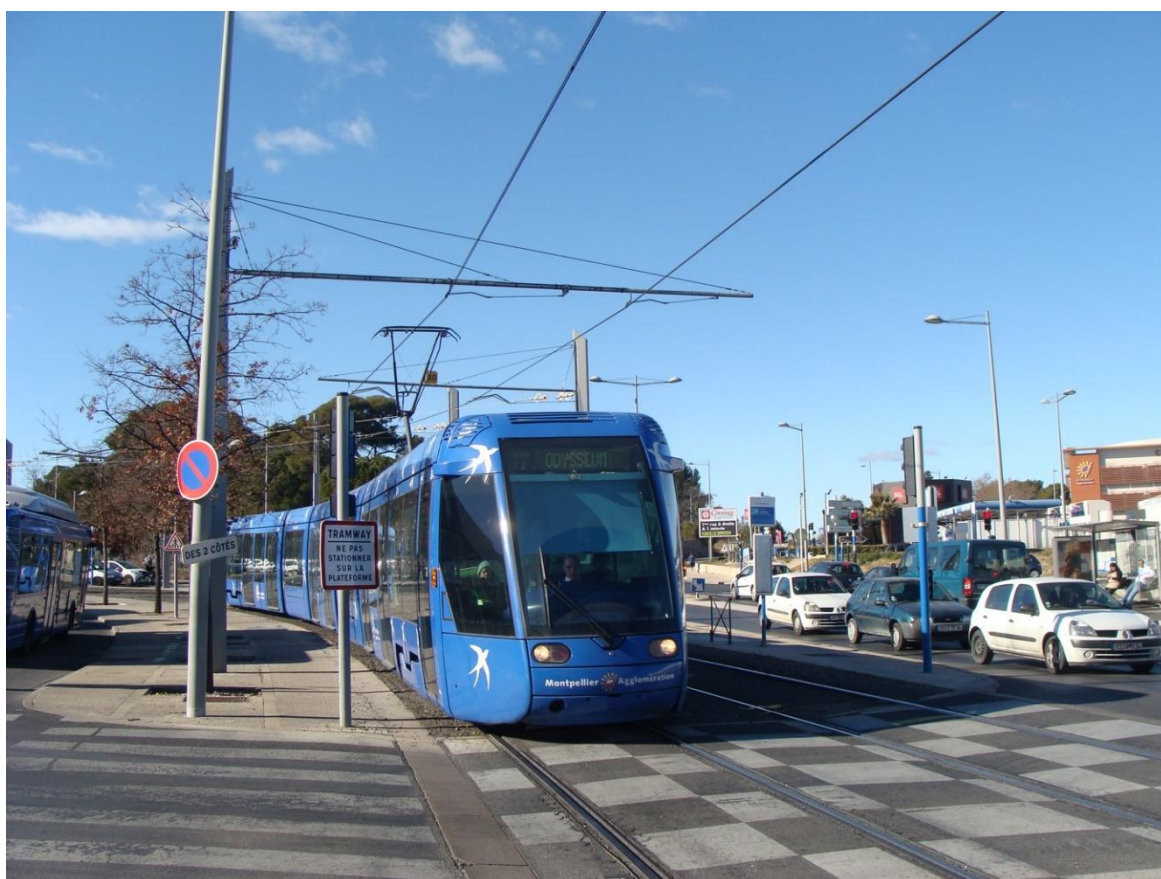
Figure 102 : le matériel CITDIS TGA 401 circulant sur le ligne 1
