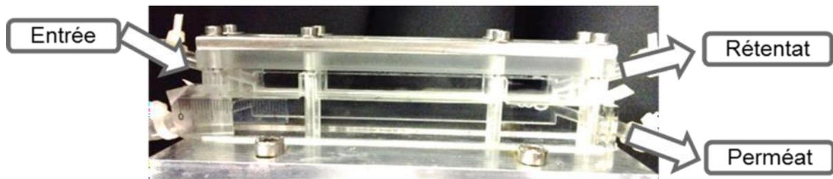
Figure 33 - Photo de la cellule de filtration pour l'expérience de Micro-PIV de Rey (2017)
