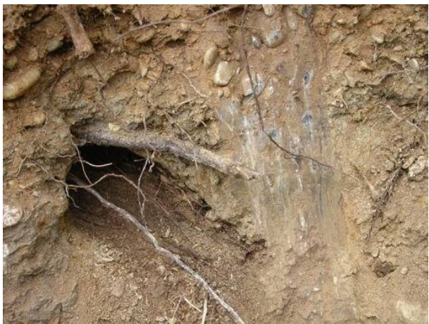
Photo I. 6 : Formation d'un renard hydraulique suite à la décomposition d'une racine (Photo : Zanetti C., 2010).
