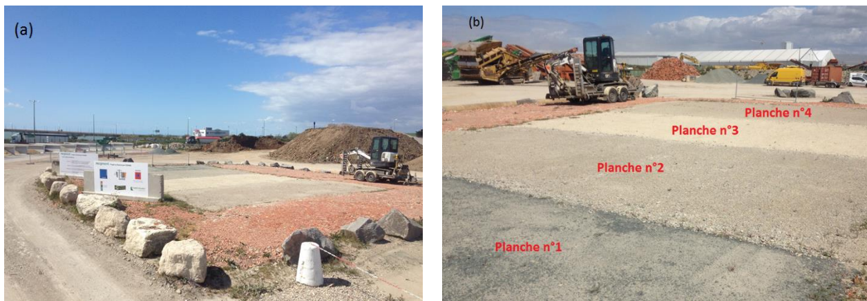
Figure 1-17 : (a) Vue d'ensemble de la plateforme expérimentale ; (b) Planche 1 : Grave dioritique 0/20 mm, Planche 2 : Grave Recyclée 0/31,5 mm, Planche 3 : Grave calcaire 0/31,5 mm et planche 4 : Grave recyclée 0/31,5 mm + 20% de sable de terre cuite 0/6 mm
