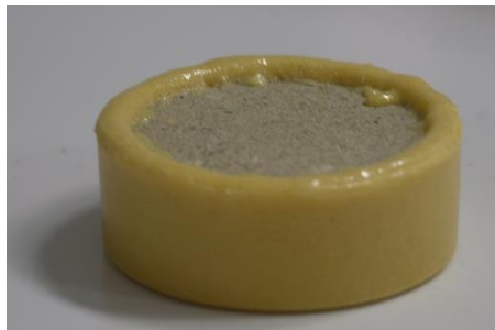
Figure 4-29 : L'échantillon SRC \phi 5H2 pour l'essai de diffusion du CO 2
