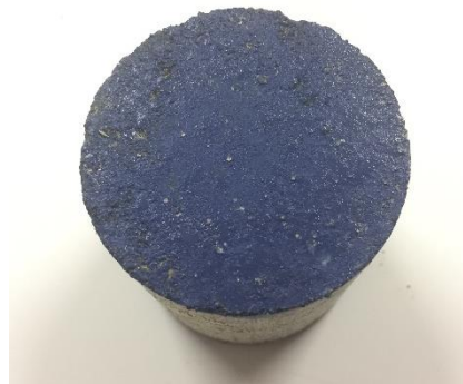
Figure 4-33 : La face supérieure de l'échantillon de SRC pour l'essai d'onde ultrasonores
