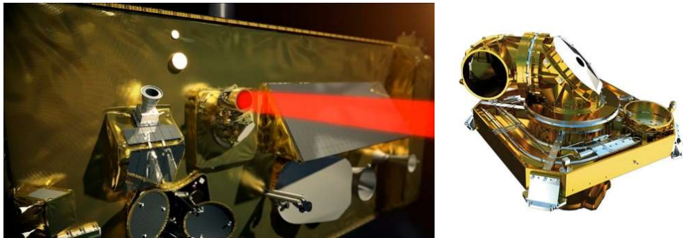
Figure 1-5 : Terminal de communication laser à bord du satellite Alphasat (ESA et Tesat Spacecom GmbH).
