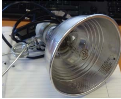
FIGURE 5.6 – Source de lumière composée d’une ampoule halogène OSRAM Classic 116W 230V et d’un réflecteur parabolique.
