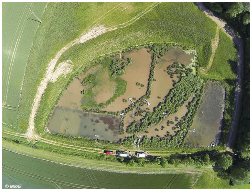
Figure 24 : Photo aérienne du bassin artificiel de Rampillon (Seine et Marne), devant servir comme milieu d'incubation test pour un prototype de système bio-électrochimique dénitrifiant en fin de projet.
