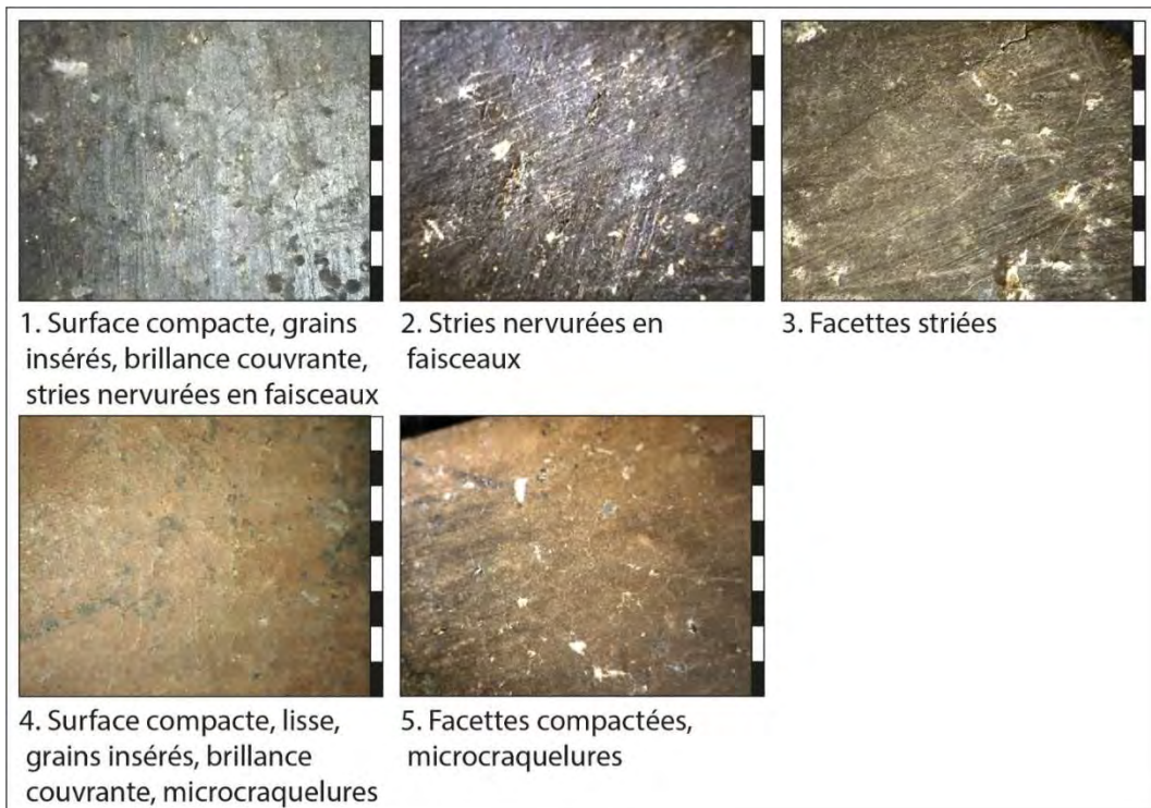
Figure 147 : photographies des principales macrotraces observées sur les surfaces brillantes. Echelle = 8 mm.
