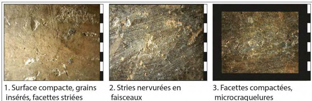
Figure 117 : photographies des principales macrotraces observées sur les surfaces brillantes. Echelle = 8 mm.
