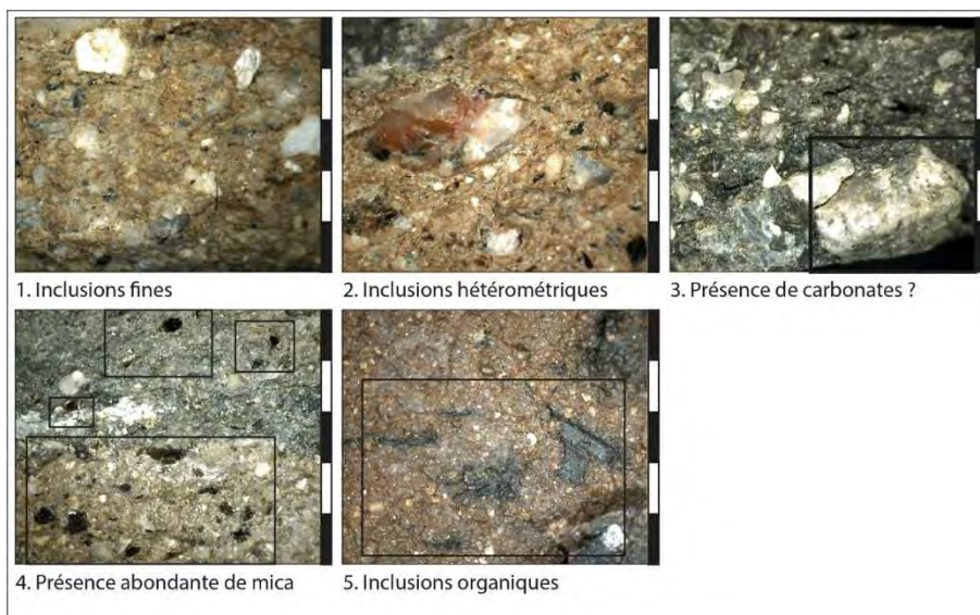
Figure 298 : photographies des principales caractéristiques observées lors de l'examen des pâtes. Echelle = 5 mm.
