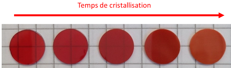
FIGURE 2.7 – Disques de 2 mm cristallisés pendant différents temps à 290^{\circ}\text{C} .
