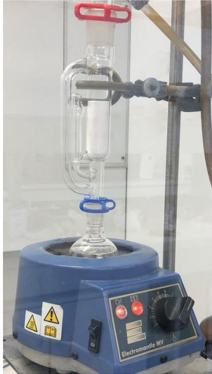
Figure A-32 : Photographie de l'appareil de Soxhlet utilisé connecté à un ballon et à un montage à reflux
