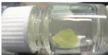
**Figure V-43** Echantillon obtenu par traitement de  $\text{Pu}_{4,67}(\text{SiO}_4)_3\text{O}$  (21) en conditions hydrothermales ( $T = 150^\circ\text{C}$ ,  $t = 20$  jours) en considérant une valeur initiale de pH égale à 4,0 (32).
