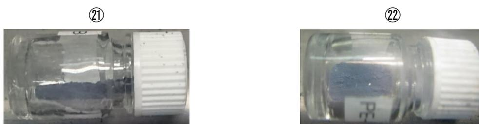
**Figure V-30** Echantillons de Pu<sub>4,67</sub>(SiO<sub>4</sub>)<sub>3</sub>O (21) et de Pu<sub>2</sub>Si<sub>2</sub>O<sub>7</sub> (22) préparés par traitement à 1350°C sous atmosphère réductrice.
