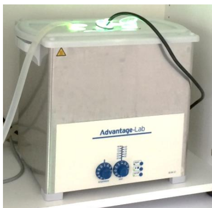
Figure II-1 : Prototype de photoréacteur à lampe à vapeur de mercure.
