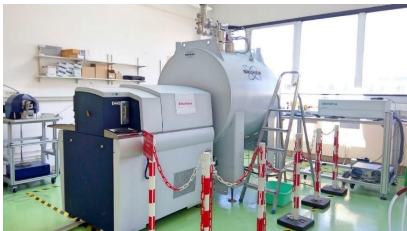
Figure II-7 : Photographie du spectromètre de masse FT-ICR SolarixXR 9.4T utilisé pour cette étude
