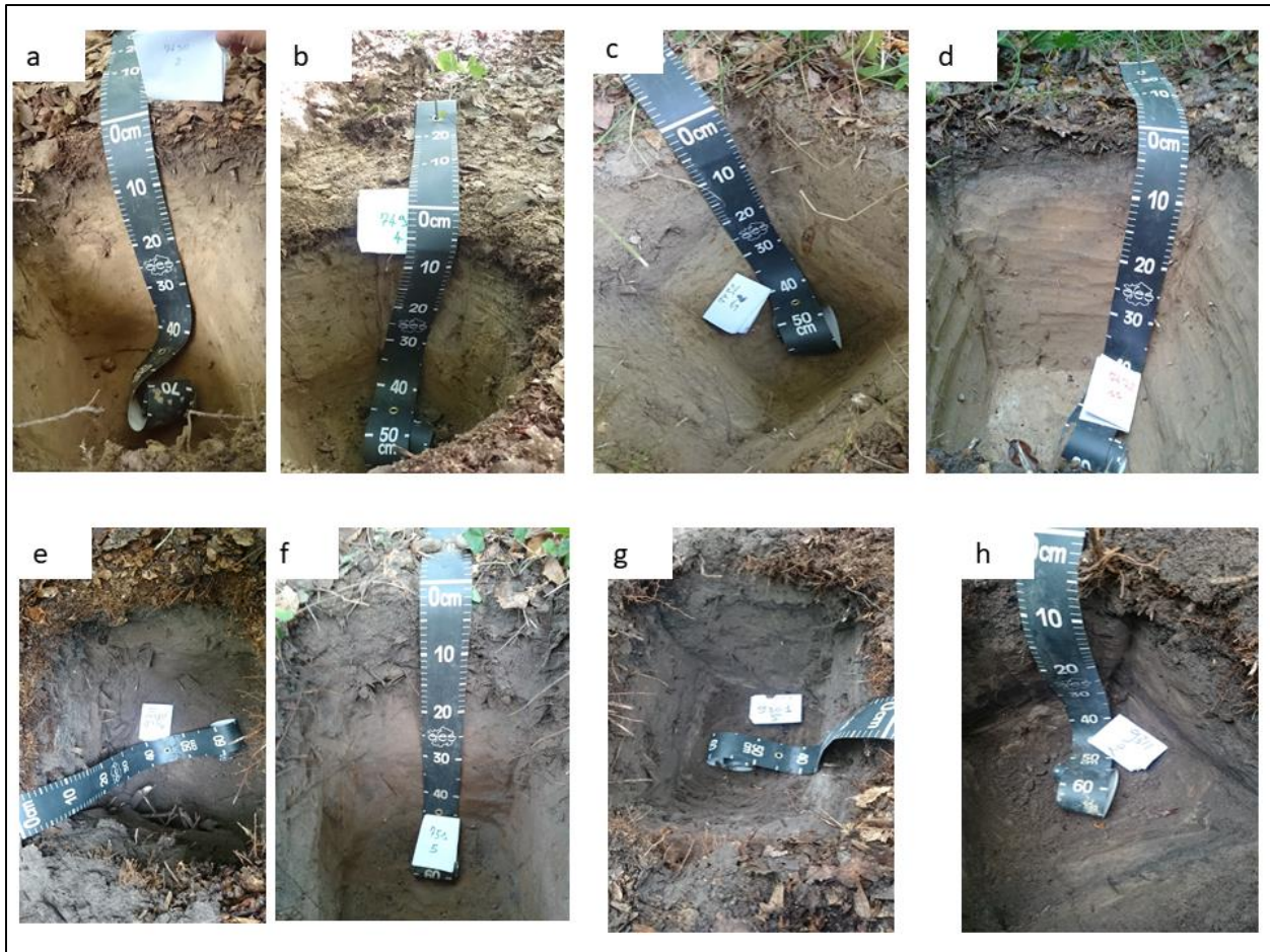
Figure 7: profil de sol par âge de compaction: a. Luvisol contrôle, b. Luvisol tassé il y a 10 ans, c. Luvisol tassé il y a 24 ans, d. Luvisol tassé il y a 45 ans, e. Podzol contrôle, f. Podzol tassé il y a 2 ans, g. Podzol tassé il y a 8 ans et h. Podzol tassé il y a 13 ans.
