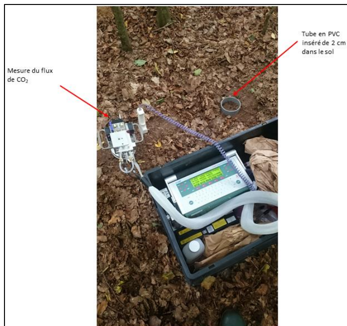
Figure 6: Un réplica de mesure sur un point de mesure montrant une mesure du flux de CO_2 et un tube en PVC de 5 cm inséré de 2 cm dans le sol.
