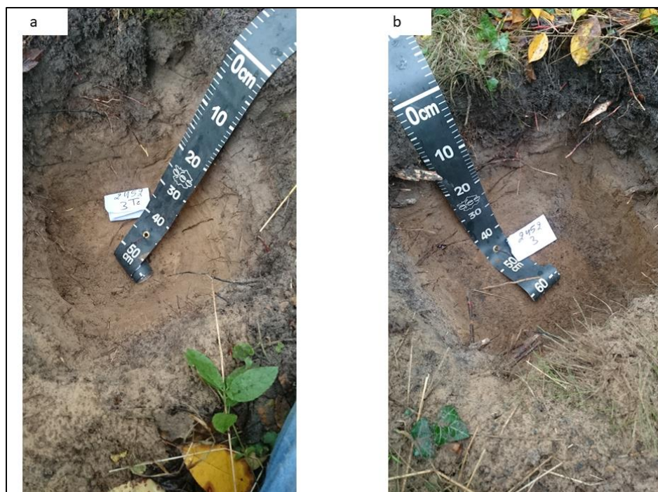
Figure 8: profil du sol sableux de l'unité de gestion tassé il y a 23 ans. a. tassé et b. contrôle
