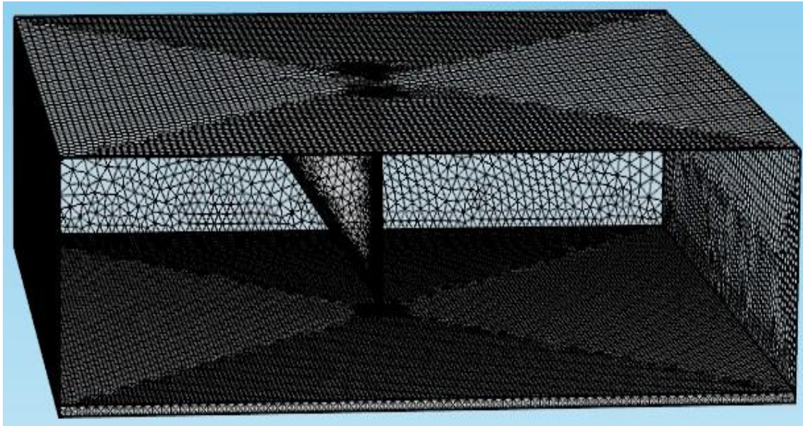
Figure II. 5 Maillage par défaut extrêmement fin pour la géométrie pointe-diélectrique.
