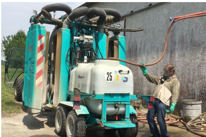
Illustration 112 : Contrôle du niveau sur les parois pendant la mise en eau de la cuve. E5, 8 mai 2018.
