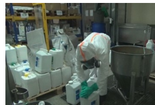
Illustration 56 : Ouverture à deux mains d'un bidon avant son incorporation en cuve intermédiaire.
