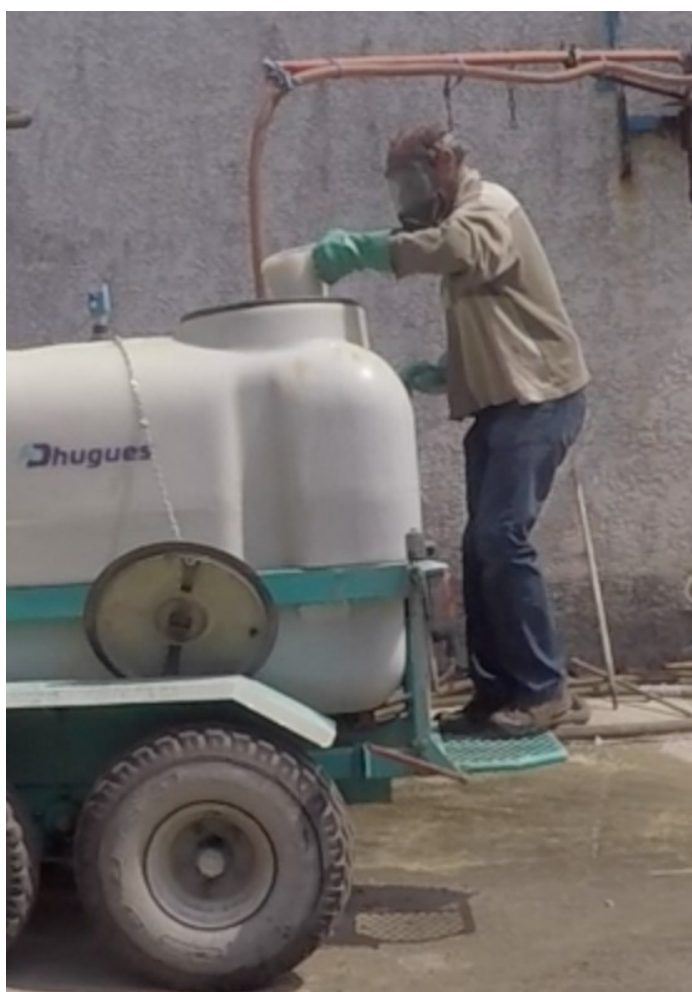
Illustration 104 : Incorporation en cuve à partir du pichet mesureur et à l'aide du marchepied. E5, 8 mai 2018.
