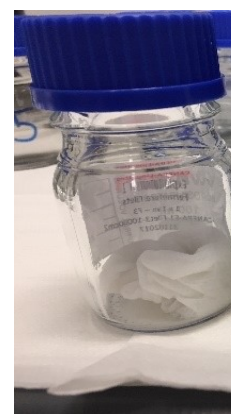
Figure 42 : Bouteille de 100 mL contenant la lingette de prélèvement par frottis.
