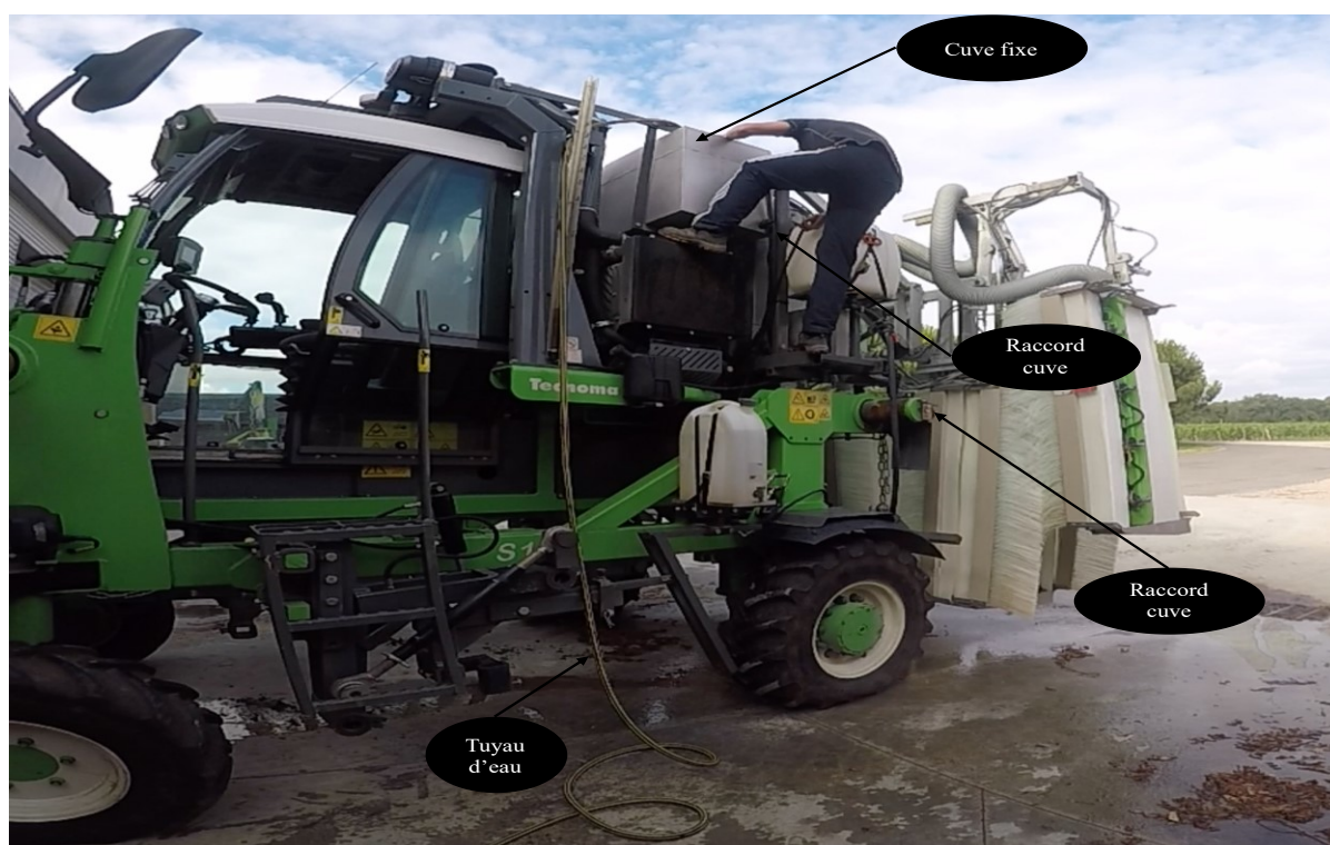
Illustration 30 : Accrochage d'un raccord de la cuve lors du remplissage manuel de la cuve fixe en eau. E1, 17 juillet, 2018.
