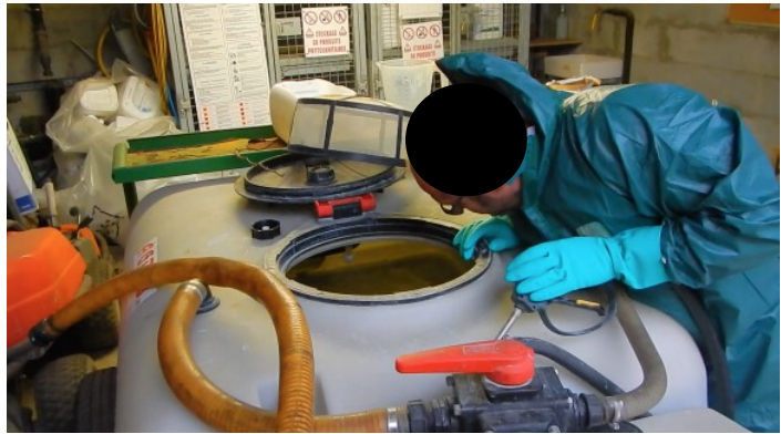
Illustration 66 : Vérification du niveau de remplissage et du bon écoulement de la bouillie. E1, 17 mai 2018.
