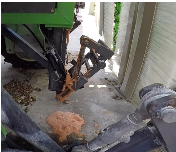
Illustration 71 : Débordement de la cuve du pulvérisateur avec une coulée de bouillie sur le matériel et le sol de l'aire de remplissage. E1, 17 juillet 2019 (Crédits photo : Marion Albert).
