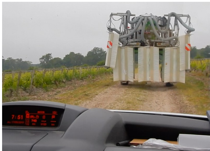
Illustration 72 : Contrôle de la pulvérisation à l'arrière du pulvérisateur. E1, 17 mai 2018 (Crédits photo : Ella Bordai).
