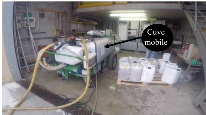
Illustration 24 : Top incorpo (cuve mobile) positionné au sein du local phytosanitaire.
