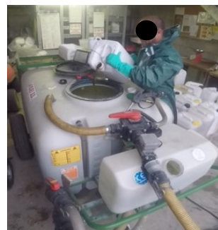
Illustration 59 : Incorporation directe d'un produit liquide en cuve intermédiaire.
