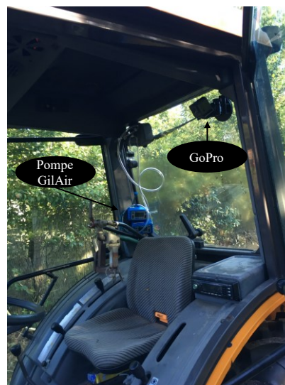
Illustration 21 : Prélèvements atmosphériques couplés au suivi de l'activité par caméra GoPro en cabine. E3, 10 août 2018.
