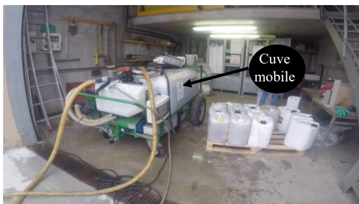
Illustration 24 : Top incorpo (cuve mobile) positionné au sein du local phytosanitaire.
