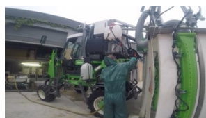
Illustration 62 : Raccordement entre la cuve d'incorporation intermédiaire et la cuve embarquée.
