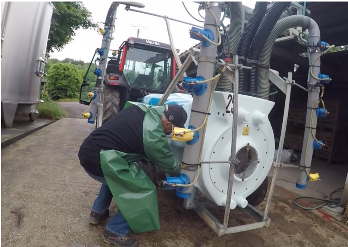
Illustration 84 : Ouverture du système de rinçage du pulvérisateur. E2, 16 mai 2018
