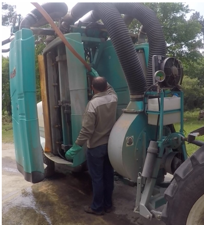
Illustration 101 : Remplissage en eau de la cuve de rinçage. E5, 8 mai 2018.
