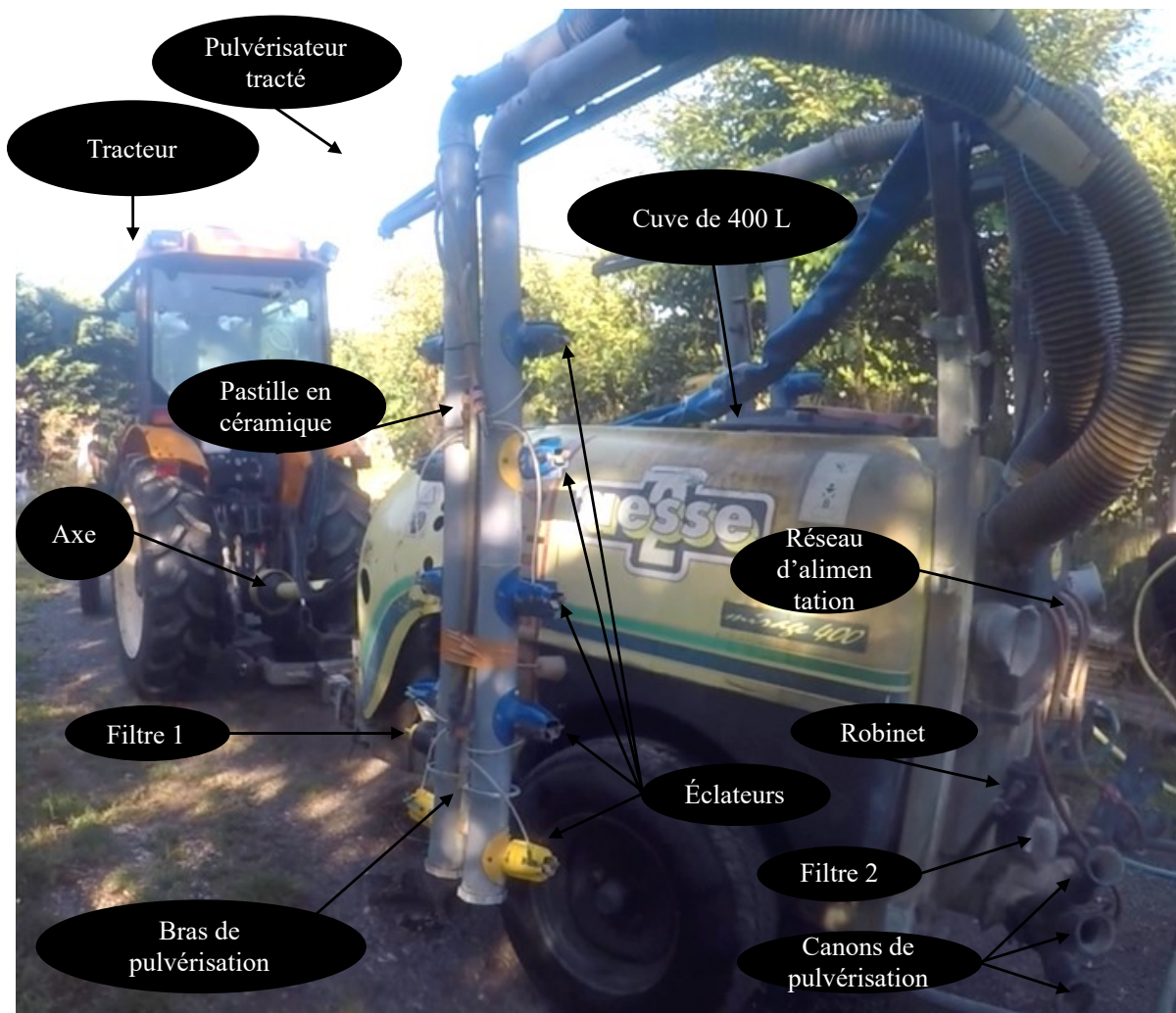
Illustration 39 : Pulvérisateur pneumatique tracté. E3.
