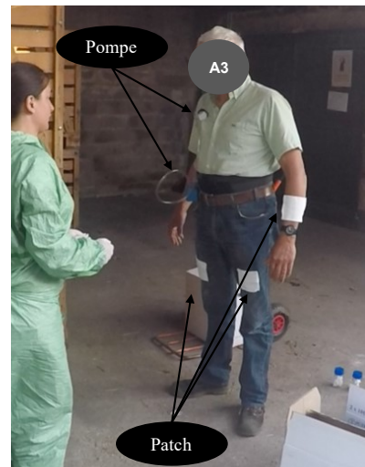
Illustration 16 : Installation des patch et de la pompe sur l'associé 3. E2, 24 juillet 2018.
