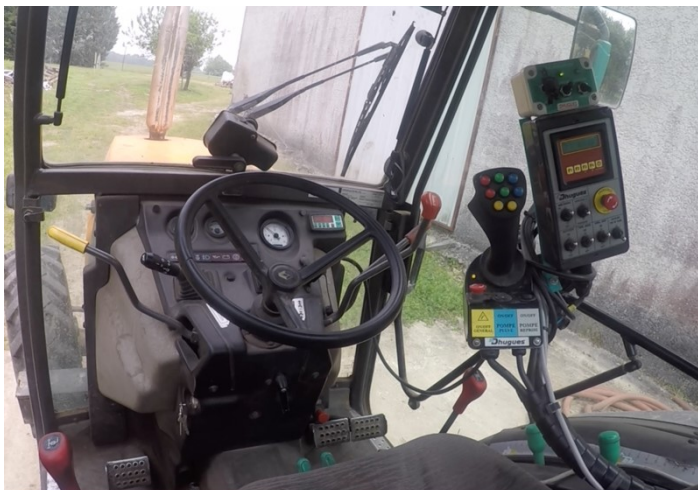
Illustration 111 : appareil de contrôle du pulvérisateur embarqué en cabine. E5, 8 mai 2018.
