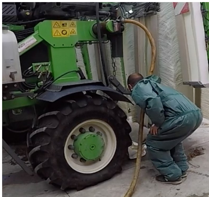
Illustration 65 : Mise en place d'un réceptacle sous le point de raccordement du pulvérisateur.
