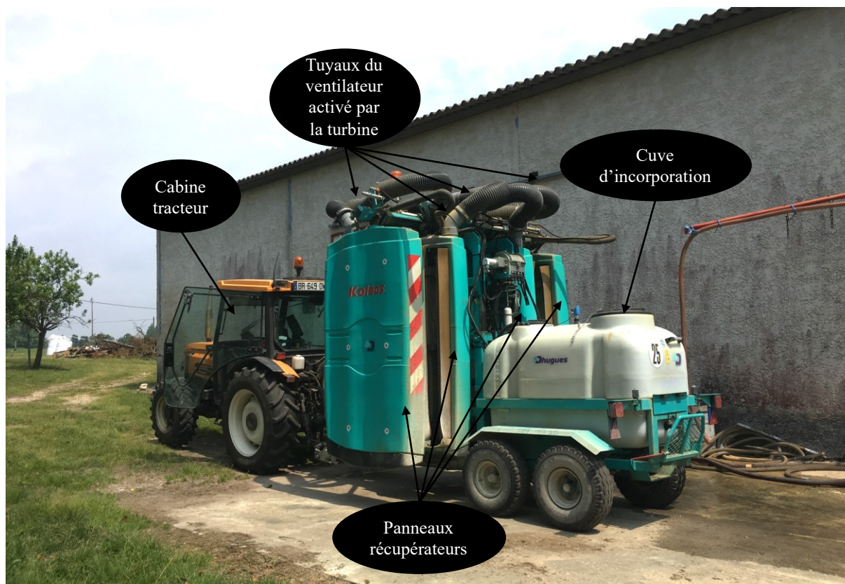
Illustration 47 : Éléments du matériel de traitement, tracteur, pulvérisateur confiné trainé. E5, 8 mai 2018.
