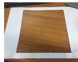
Figure 41 : Exemple de gabarit utilisé pour le prélèvement sur une surface plane (25 x 25 cm).
