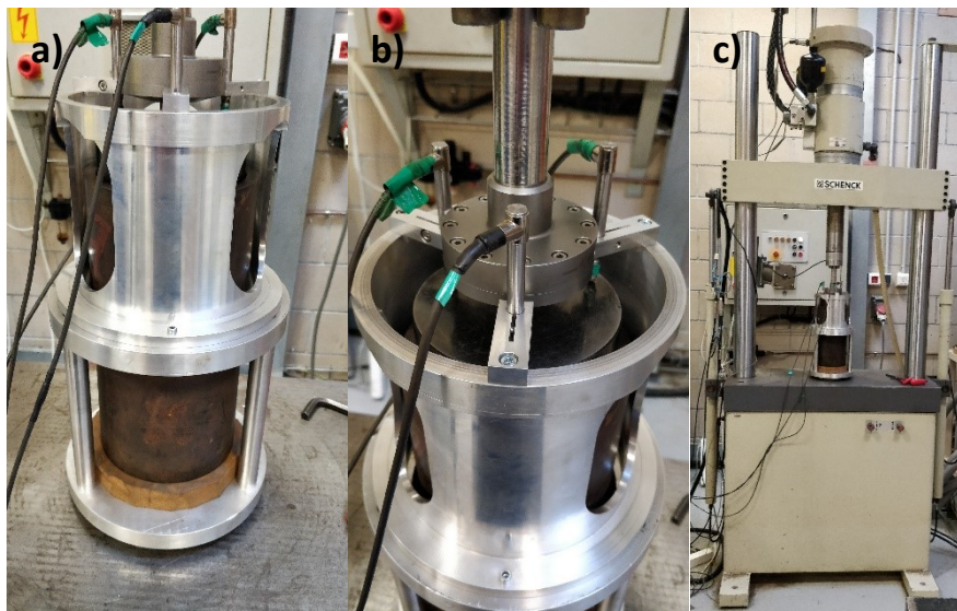
Figure 9 : a) Epreuve placée dans le dispositif d'essai (échantillon en haut, cale en bas), b) Disposition des capteurs LVDT sur le casque, c) Montage dans la presse.
