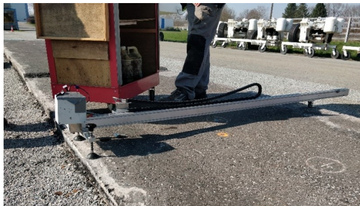
Figure 26 : Dispositif de mesure de profil en travers.
