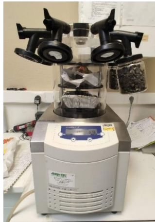
Figure 1 : Lyophilisateur utilisé, Alpha 1-2 LDplus Bioblock-Christ.
