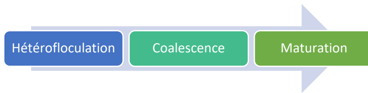
Figure 14 : Etapes par lesquelles passe une émulsion de bitume pendant et après l'enrobage.
