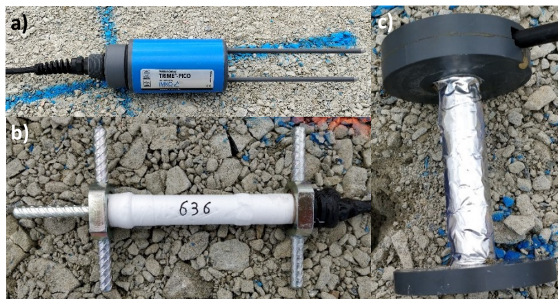
Figure 33 : Exemples de jauges et sonde placées dans la chaussée, a) sonde de teneur en eau (Trime pico 32 IMKO), b) jauge de déformation horizontale (KM 100 HAS Tokyo Measuring Instruments Lab), c) jauge de déformation verticale (KM 100 A Tokyo Measuring Instruments Lab).
