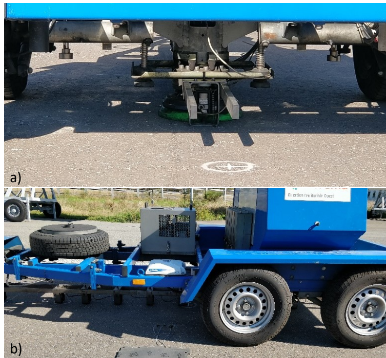
Figure 21 : a) Charge du HWD, b) HWD avec géophones visibles.
