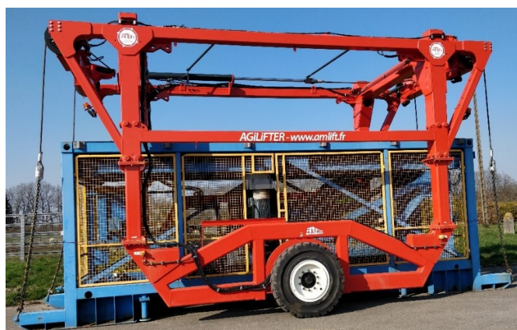
Figure 22 : FABAC équipé de son chariot cavalier Agilifter.
