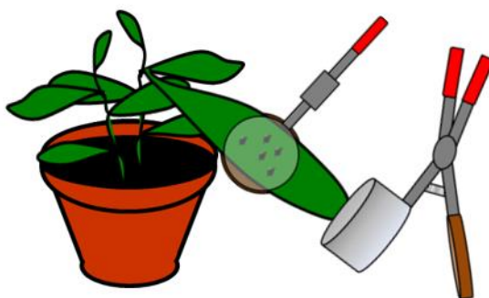
Fig. 7. Dispositif de suivi physiologique « clip-cage ».
