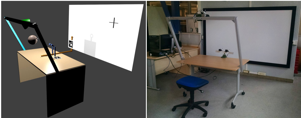
FIGURE 3.30 – Banc de test pour l'acquisition de données et l'évaluation d'oculomètres. (gauche) Simulation du banc de test avec en bleu les deux caméras de l'oculomètre, en vert la caméra de scène fixée sur un portique et en orange la cible tendue à la main par l'utilisateur. (droite) Photo du banc de test réel où l'affichage sur l'écran est généré par un projecteur fixé au plafond.
