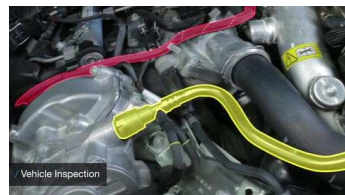
FIGURE 2.23 – Exemple d'un affichage de contenu synthétique dont la structure géométrique est issue de la scène réelle.
