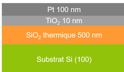
FIGURE 4.24 – Empilement utilisé pour étudier la croissance de \text{LiNbO}_3 sur électrode de platine.
