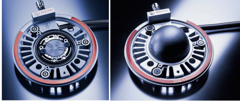
FIGURE 2.6 – Image du four utilisé pour recuire à haute température in-situ [13].
