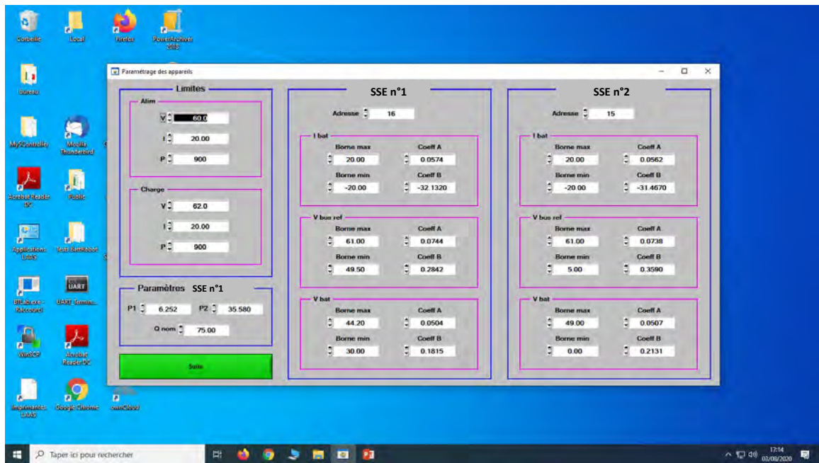
FIGURE II.9 – Interface de réglage des paramètres de sécurité du banc de test
