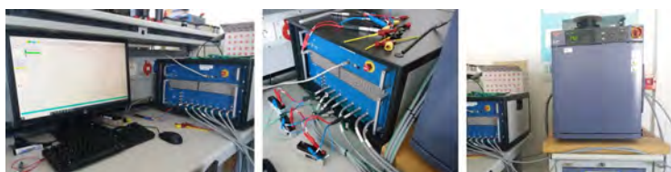
FIGURE 1 – Ensemble des éléments du banc de test pour SSE (de droite à gauche : PC avec le logiciel BTLab, banc Biologic, chambre thermique ESPEC)
