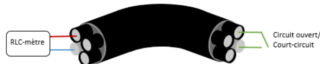
Figure 1-6 : Configuration de mesure des impédances d'entrée Z_{cc-in} et Z_{co-in} en utilisant un RLC-mètre
