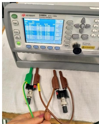
Figure 2-8 : Caractérisation des charges à l'aide d'un RLC-mètre
