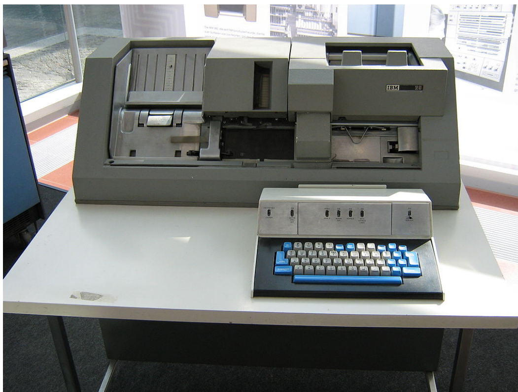
Figure 3. Exemple de perforatrice utilisée à la fin des années 1960 (ici le modèle IBM 029 introduit sur le marché en 1964)
