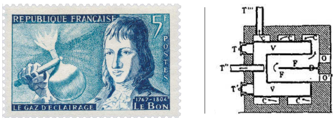
Figure 17 - Timbre à l'effigie de Philippe Lebon (1955) et schéma de la "thermolampe" issu du brevet déposé en 1799
