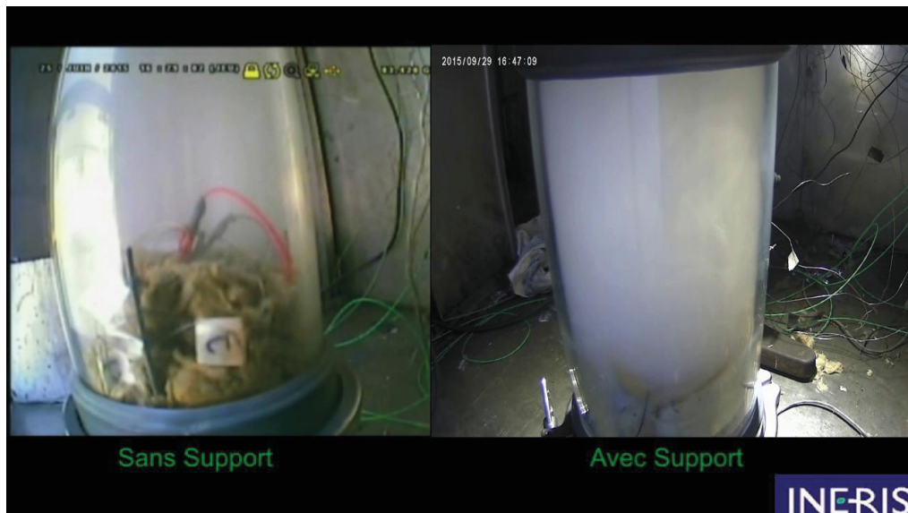
Figure 24 : Capture d'écran de la vidéo au moment de l'emballement thermique lors des tests sans support (avec contre-pression) et avec support (sans contre-pression).
