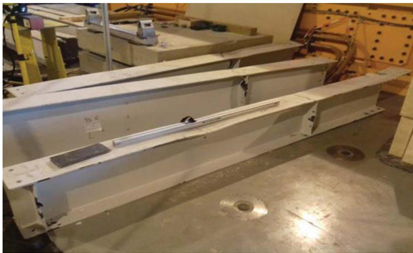
Figure II-6 : Poutres PRS utilisées pour la campagne d'essais n°1
