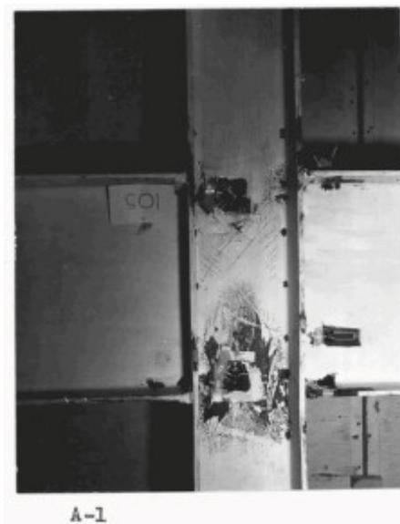
Figure I-38 : Assemblage non raidi testé par (Graham et al. 1959)
