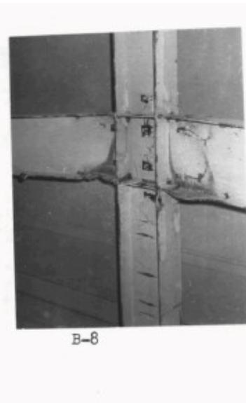
Figure I-39 : Assemblage raidi testé par (Graham et al. 1959)
