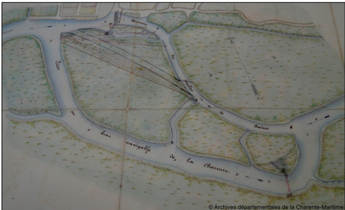
Fig. 147 – Plan général du fleuve Charente aux abords des moulins de la Baine pour la construction de l'écluse, du canal de dérivation et du barrage (1838-1842) (AD17, S5945, 25 octobre 1838).
