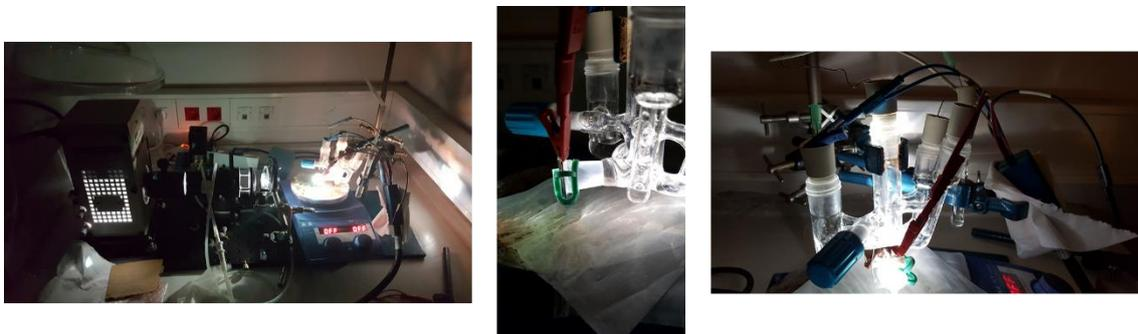
**Figure 4.29 :** Photos du montage photo-électro-chimique. A gauche la lampe en face de la cellule, au milieu système de fixation de la plaque ITO permettant de l'éclairer par la face de verre tout en immergeant la face conductrice dans l'électrolyte et à droite la cellule étanche à deux compartiments.
