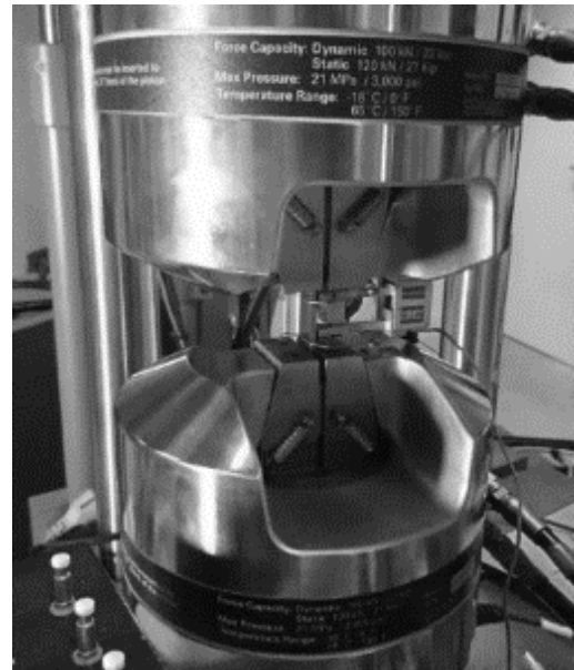
Fig. 169 - Machine d'essai de traction avec extensomètre.
