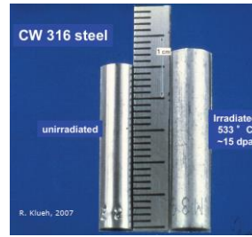
Fig. 211 - Gonflement (effet du regroupement des lacunes) de l'acier CW 316 (Klueh, 2008).
