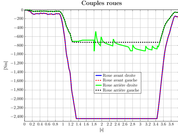
FIGURE 4.1 – Modèle MADA : exemple des couples roues.
