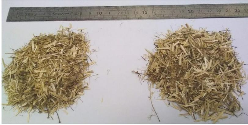
Figure II-27 : Anas de lin calibré avec les grilles G7 à gauche et G14 à droite
