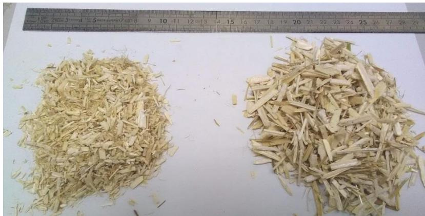
Figure II-26 : Chènevotte calibrée avec les grilles G7 à gauche et G14 à droite
