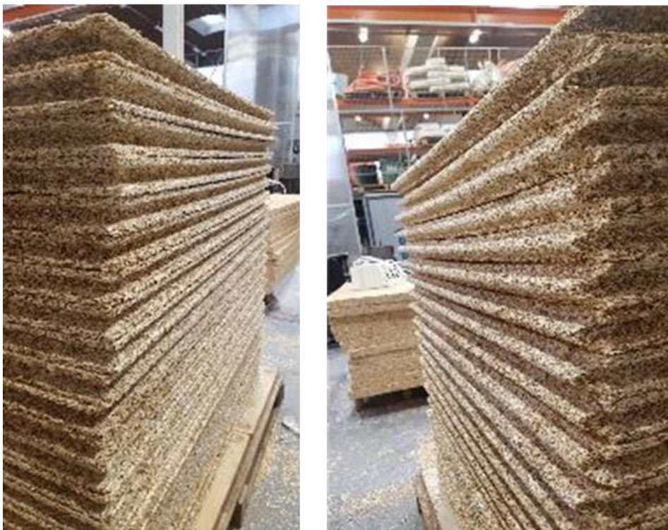
Figure V-16 : Profils rainures et languettes des panneaux qui facilitent leur installation sur chantier (réduction des ponts thermiques)
