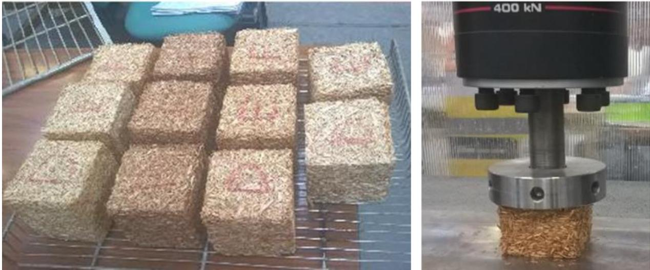
**Figure III-1 : Composites fabriqués pour la comparaison des réticulants par essai de compression**
