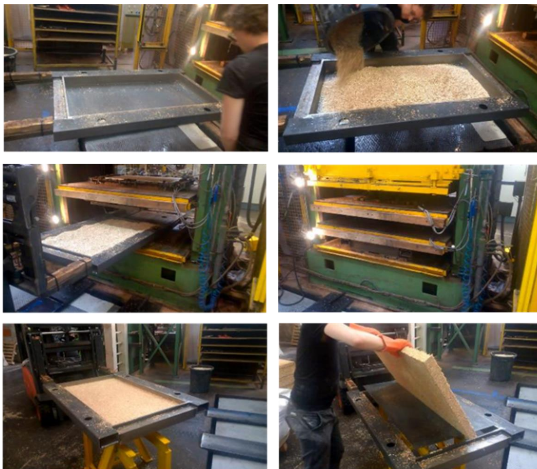
Figure V-13 : Illustration des étapes de fabrication des panneaux rigides isolants
