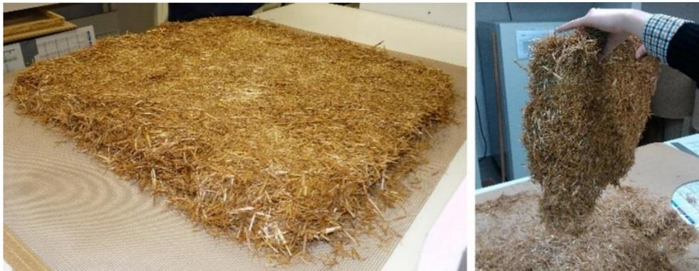
Figure IV-5 : Panneaux de paille après traitement thermique
