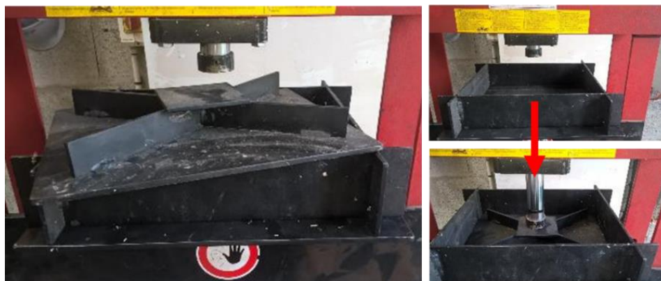
Figure IV-4 : Dispositif de prépressage à froid
