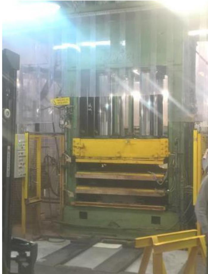
Figure V-10 : Thermopresse industrielle utilisée pour le prototypage des panneaux rigides isolants de chènevotte
