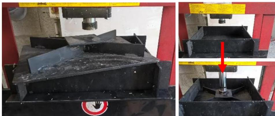
Figure IV-4 : Dispositif de pré-pressage à froid
