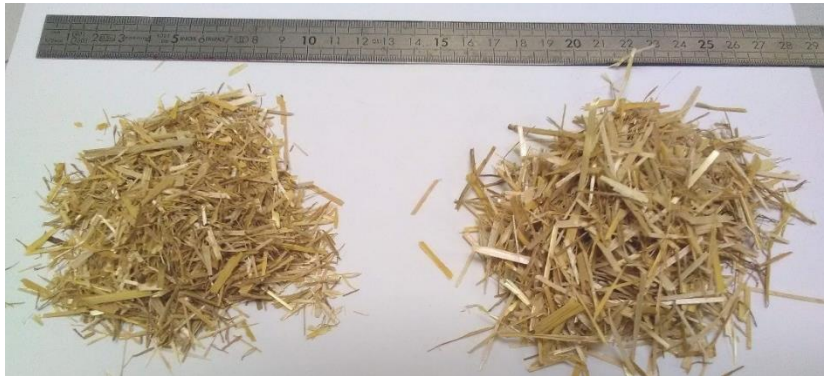
Figure II-28 : Broyats de paille de blé calibrés avec les grilles G7 à gauche et G14 à droite
