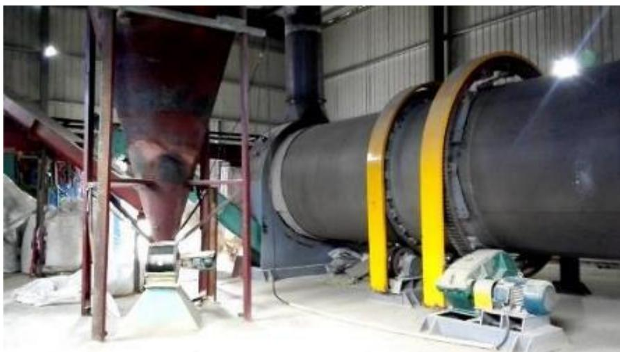
Figure V-11 : Séchoir à tambour rotatif pour particules de bois (S. Zhang, 2016)
