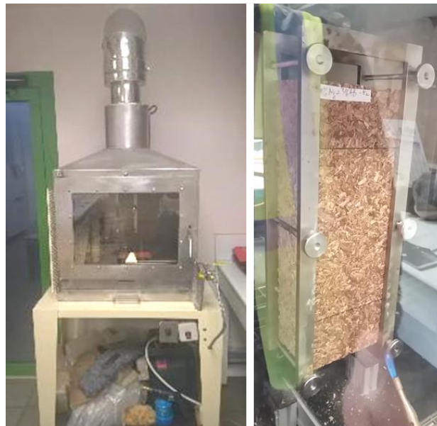
Figure II-20 : Dispositif expérimental pour l'essai à la petite flamme
