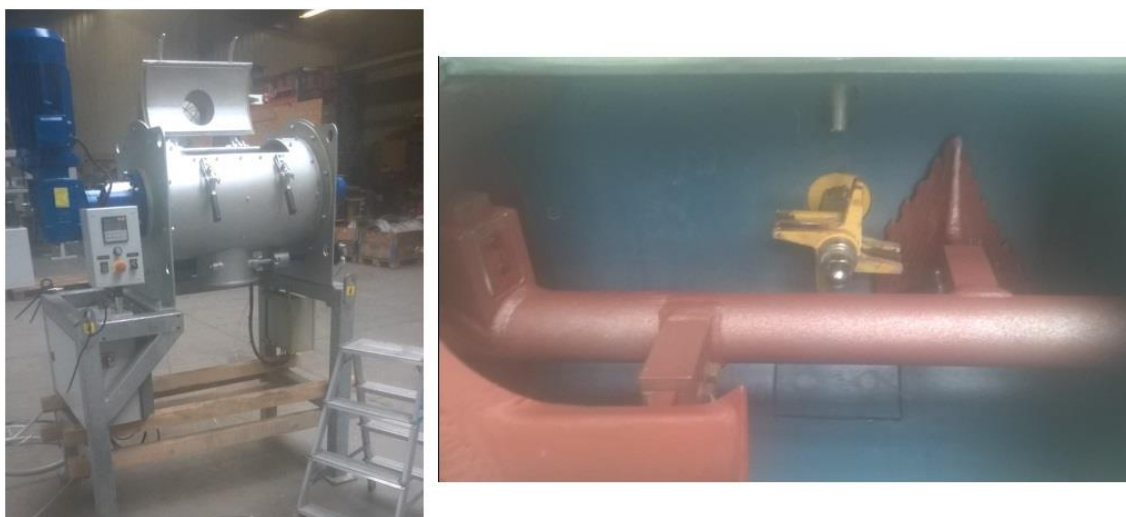
Figure V-1: Mélangeur à socs utilisé pour appliquer et mélanger le liant avec la chènevotte a. mélangeur (vue extérieure), b. pales et buse de pulvérisation (vue intérieure)
