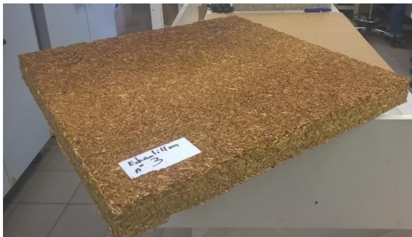
Figure IV-9 : Panneau rigide isolant de chènevotte fabriqué à partir du procédé de thermopressage.
