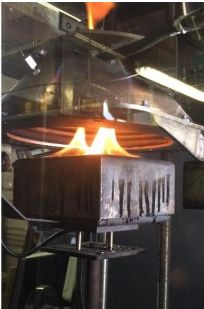
Figure II-21: Chambre de combustion du calorimètre à cône
