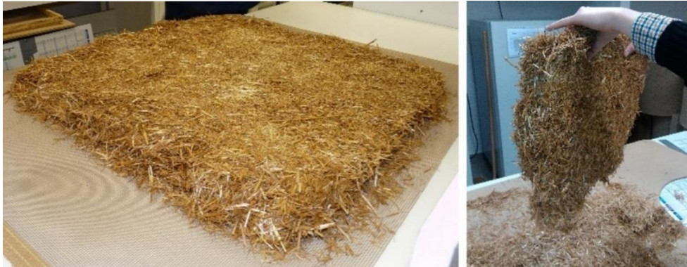
Figure IV-5 : Panneaux de paille après traitement thermique
