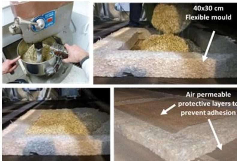
Figure IV-3 : Mélange liant granulates et conformation du mat sur la bande de convoyage
