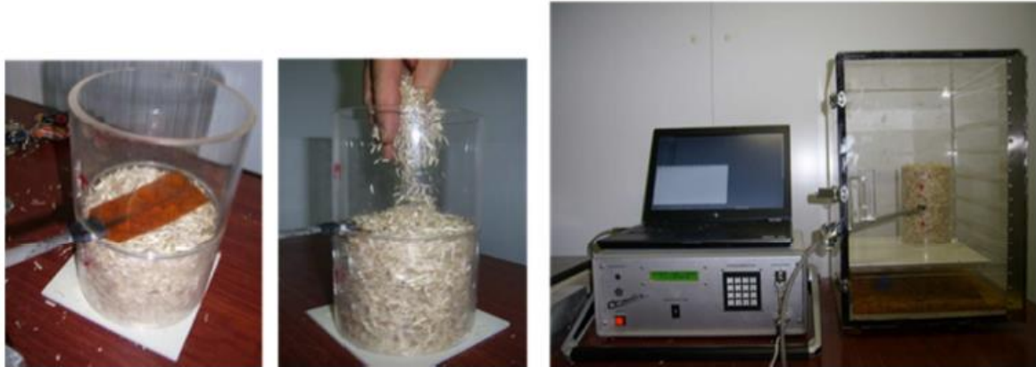
Figure II-5 : Dispositif de mesure de la conductivité thermique en vrac par la méthode du fil chaud (Amziane et al., 2017)
