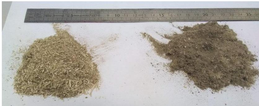
Figure II-29 : Fines de chanvre (à gauche) et fines de lin (à droite)
