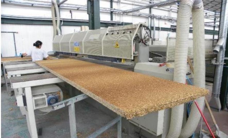
**Figure V-23 : Découpe des panneaux aux dimensions finales**
