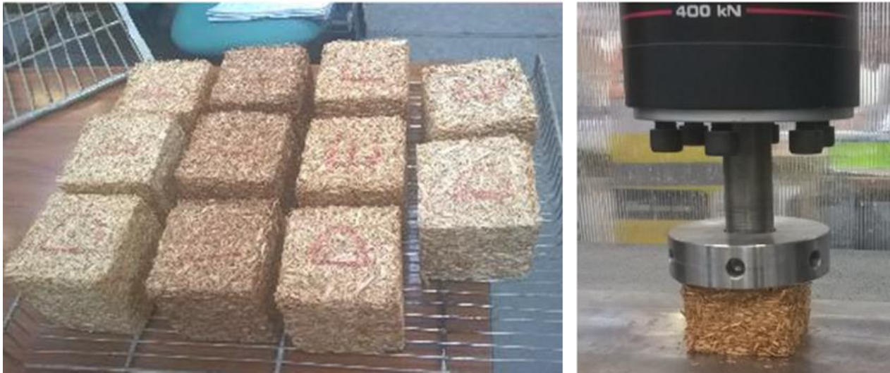
Figure III-1 : Composites fabriqués pour la comparaison des réticulants par essai de compression
