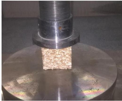
Figure II-16 : Essai de compression
