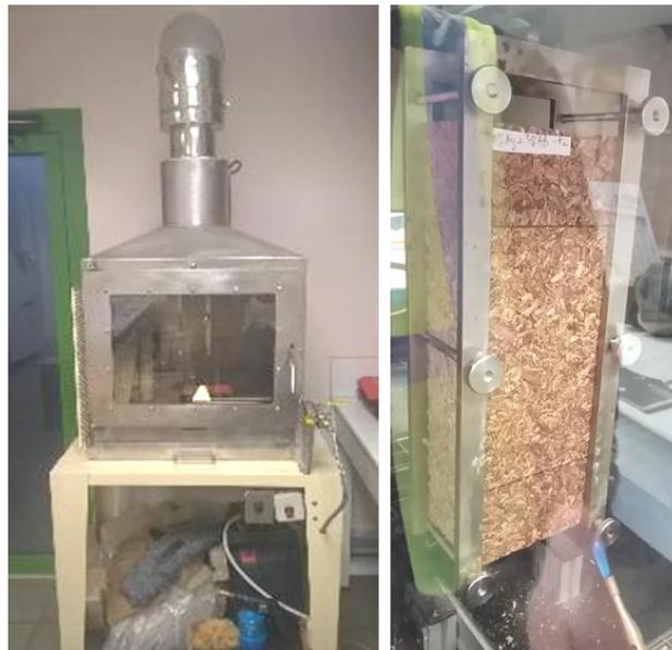
Figure II-20 : Dispositif expérimental pour l'essai à la petite flamme
