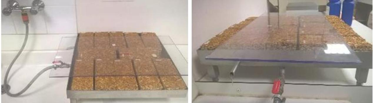
**Figure II-19 : Dispositif expérimental pour la détermination de l'absorption d'eau à court terme par immersion partielle**
