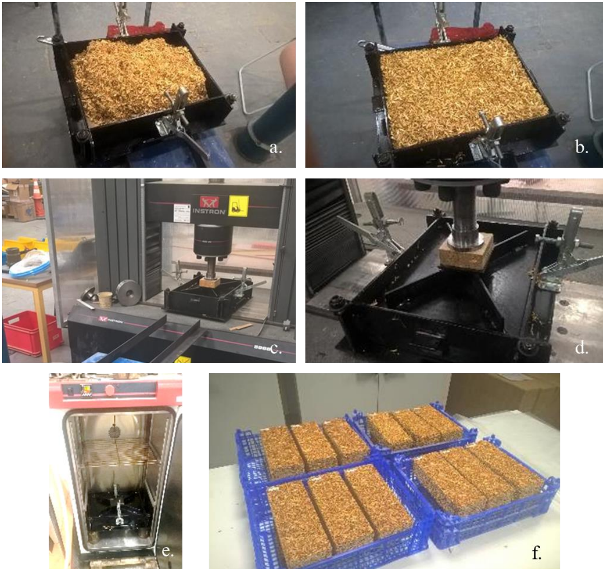
Figure II-8 : Etapes de fabrication des composites 300 mm x 400 mm x 50 mm par moulage
