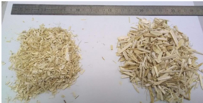
Figure II-26 : Chènevotte calibrée avec les grilles G7 à gauche et G14 à droite
