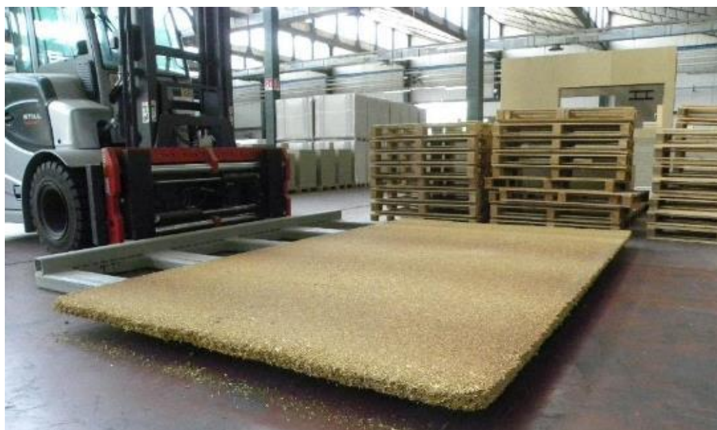
Figure V-22 : Panneau rigide isolant de chènevotte (dimensions 2 m x 4 m)
