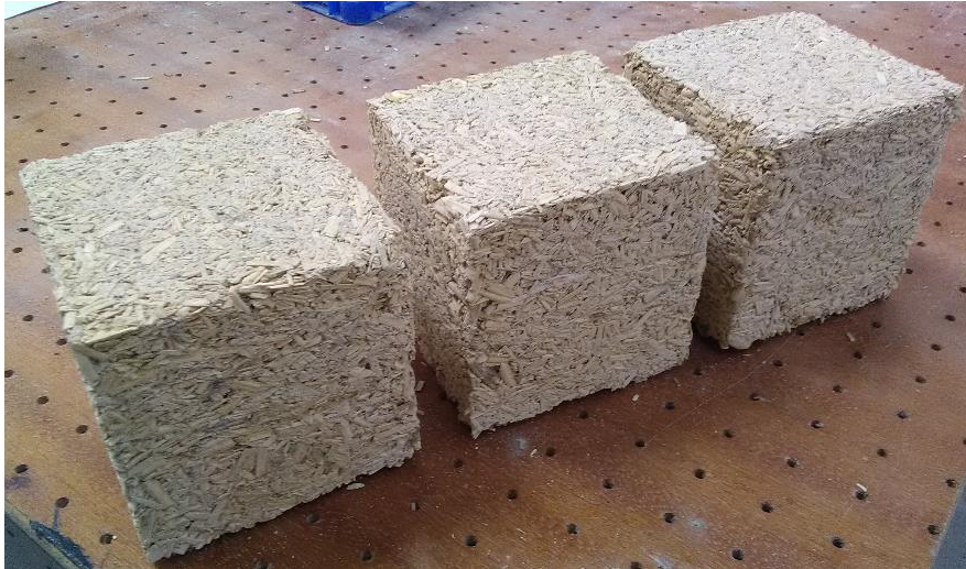
Figure III-3 : Composites chènevotte - liant oxysulfate de magnésium
