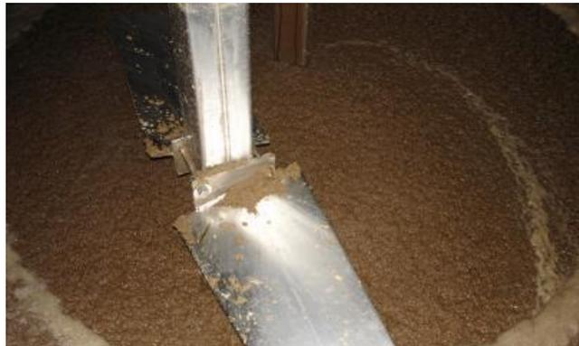
**Figure I-20 : Dispersion des fibres dans l'eau (Gutex, 2012)**
