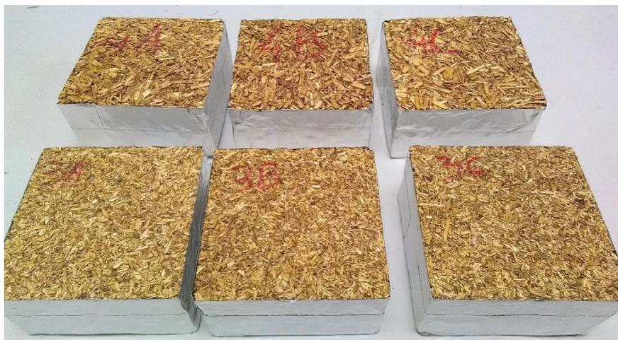
Figure IV-23 : Echantillons étanchés pour la mesure du MBV
