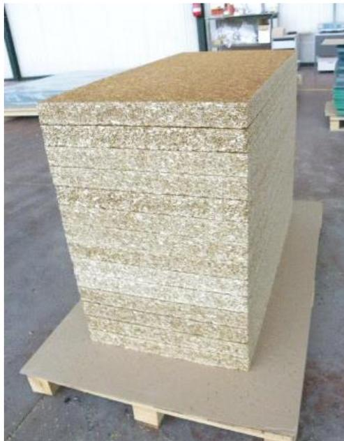
**Figure V-25 : Panneaux rigides isolants aux dimensions finales (sans profil rainure et languette)**
