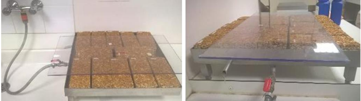
Figure II-19 : Dispositif expérimental pour la détermination de l'absorption d'eau à court terme par immersion partielle
