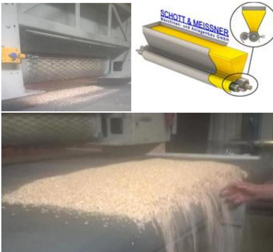
**Figure V-2 : Unité de saupoudrage utilisée pour former en continu le mat sur le tapis de convoyage**
