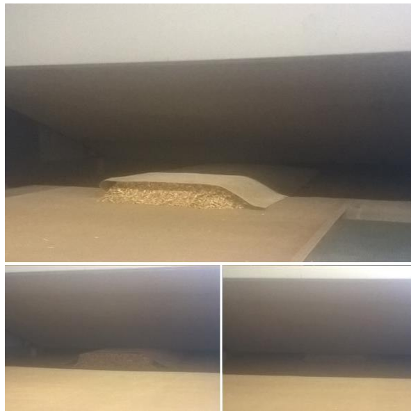
Figure V-8 : Pré-pressage du mat à l'aide de l'unité de préchauffage
