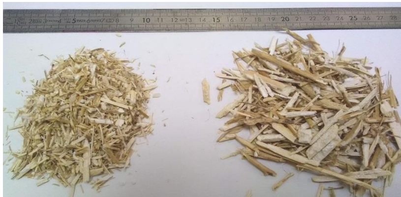
Figure II-25 : Broyats de paille de colza calibrés avec les grilles G7 à gauche et G14 à droite
