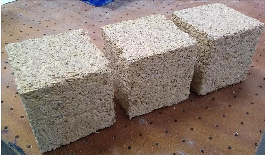
Figure III-3 : Composites chènevotte - liant oxysulfate de magnésium
