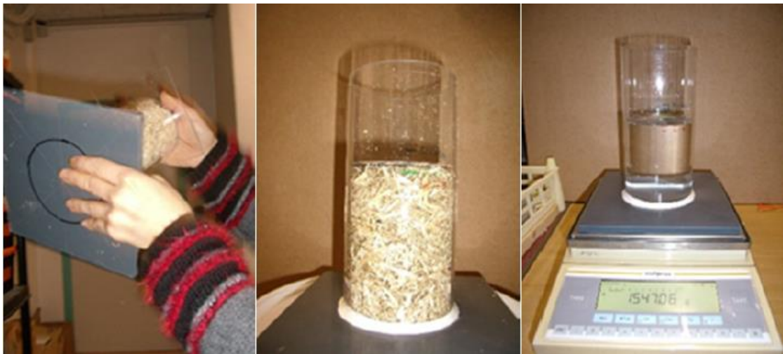
Figure II-3 : Dispositif de mesure de la masse volumique apparente en vrac des granulats végétaux
