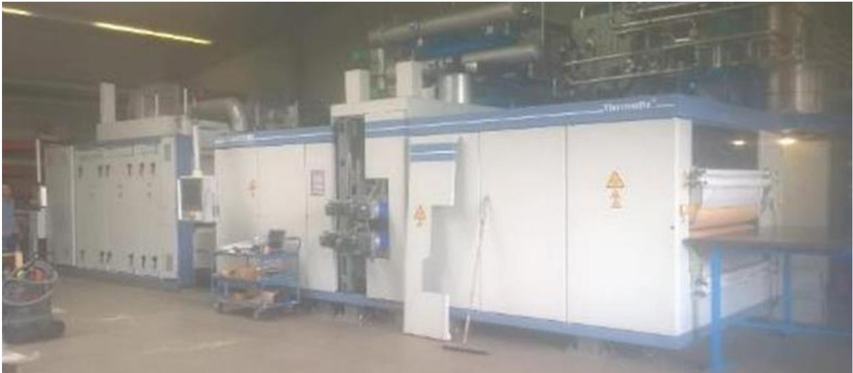
Figure V-3 : Ligne pilote utilisée pour tester la fabrication en continu du panneau rigide de chènevotte.
