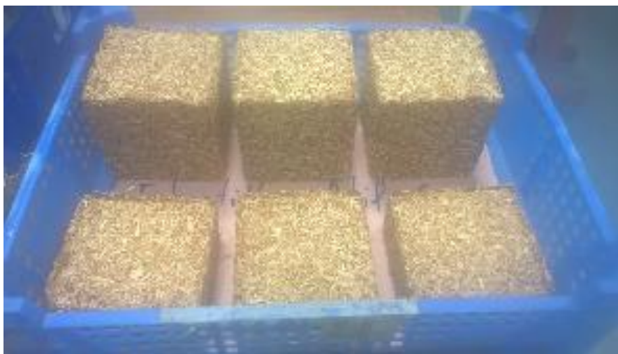
Figure II-7 : Echantillons composites 100 mm x 100 mm x 100 mm fabriqués par moulage
