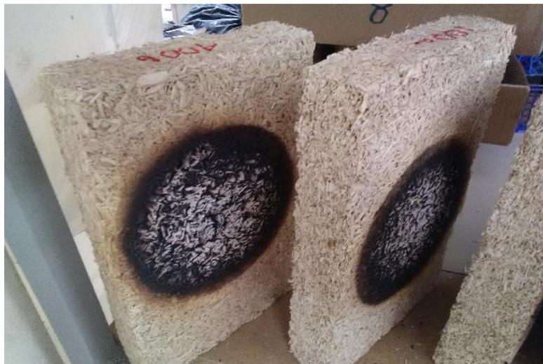
**Figure VI-25 : Échantillons C100 après l'essai au brûleur**
