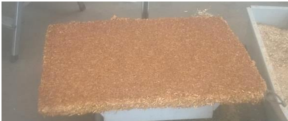
Figure V-9 : Panneau rigide de chènevotte obtenu après optimisation des paramètres
