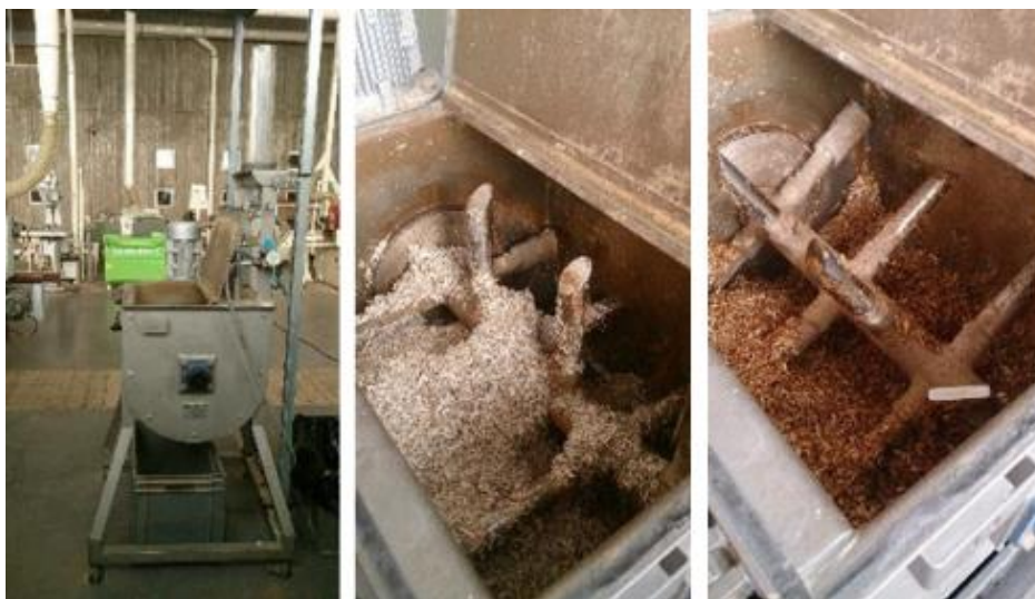
Figure IV-7 : Encolleur de laboratoire Imal Pal pour panneaux de particules contenant des buses de pulvérisation
