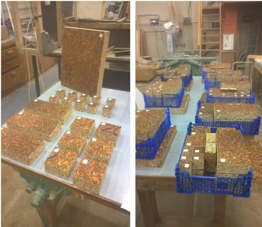
Figure IV-10 : Échantillons découpés pour caractérisation
