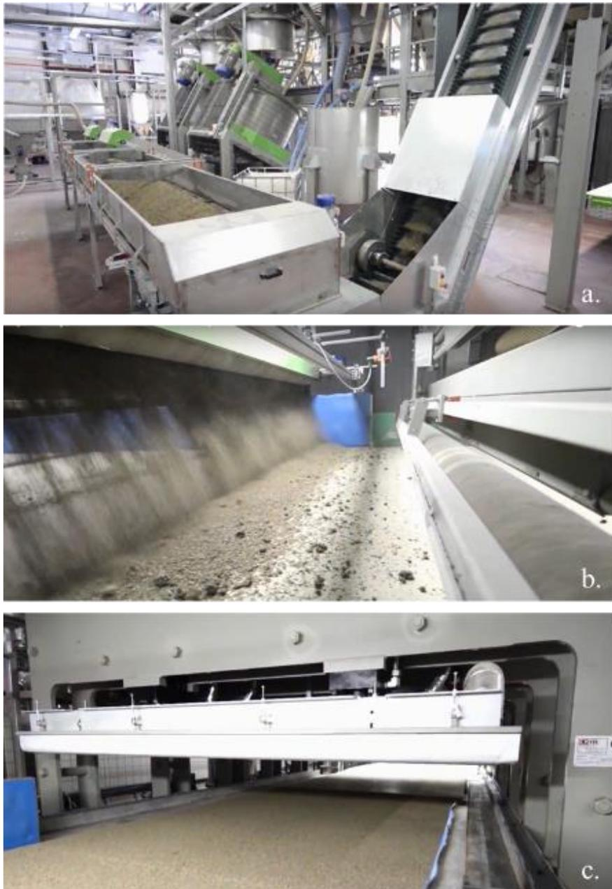
**Figure V-20 : Ligne industrielle utilisée pour la production des panneaux rigides de chènevotte.**
