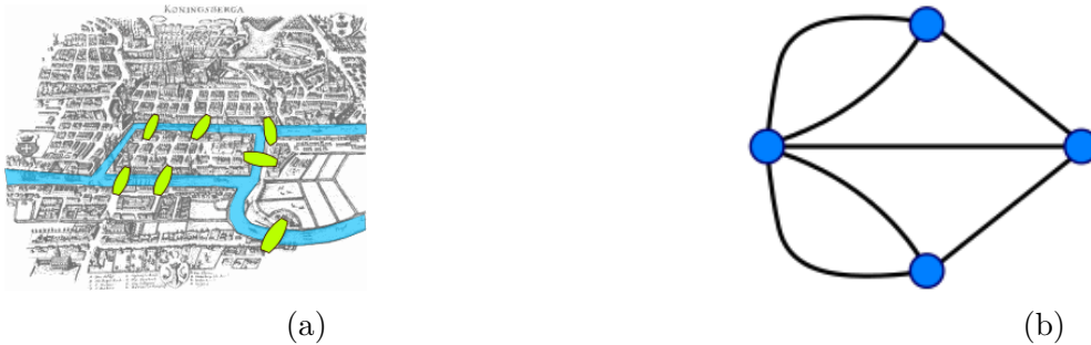
FIGURE 2.1 – Le problème des sept ponts de Königsberg étudié par Euler [42] (source des images : Wikipédia). (a) représente la carte de la ville de Königsberg au temps d'Euler mettant en évidence la rivière Pregel et les sept ponts. (b) est la modélisation de cette carte sous forme de graphe où les nœuds représentent les îles et les deux parties continentales et où les arêtes représentent les ponts.
