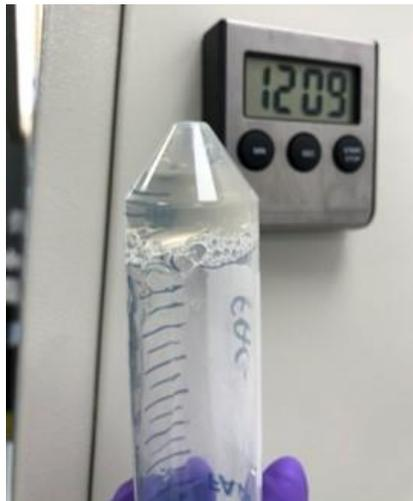
**Figure 62** Photo de la gélification de la bioencres en 12 minutes à 21°C.
