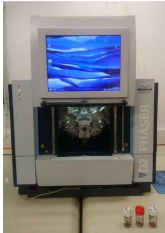
Figure II-1 : Diffractomètre de rayons X Bruker D2 Phaser du GET.
