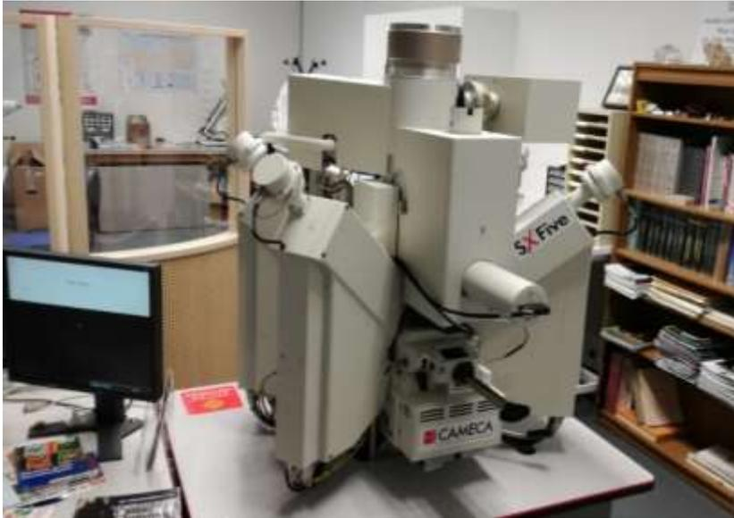
Figure II-4 : Microsonde électronique SXFive du Centre de micro-caractérisation Raimond Castaing" (Toulouse, France).
