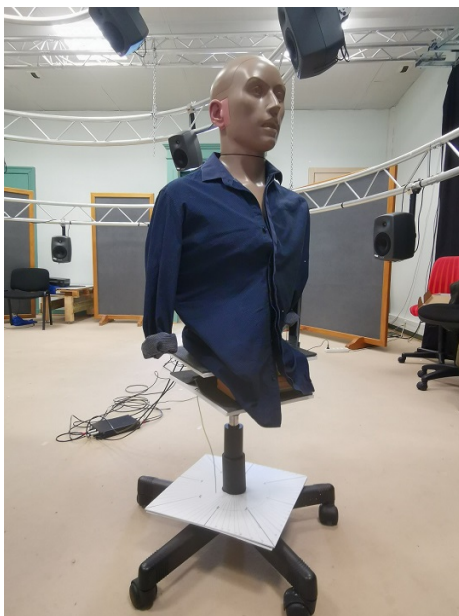
FIGURE 11.17 – Second système de prises de mesure, plus efficace, constitué d'un support de chaise de bureau et un support TV inclinable solide.
