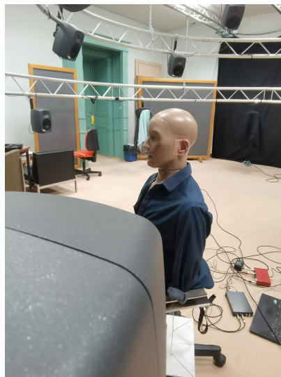
FIGURE 8.9 – Exemple d'enregistrement effectué pour les tests d'indépendance de la distance dans le studio du SCRIME. Ici pour une distance d = 2m et un azimut \theta = 0^\circ .
