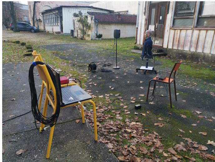
FIGURE 8.8 – Exemple des tests d'enregistrement dans des conditions extérieures (ici pour un azimut \theta = 80^\circ et une distance d = 2m ).
