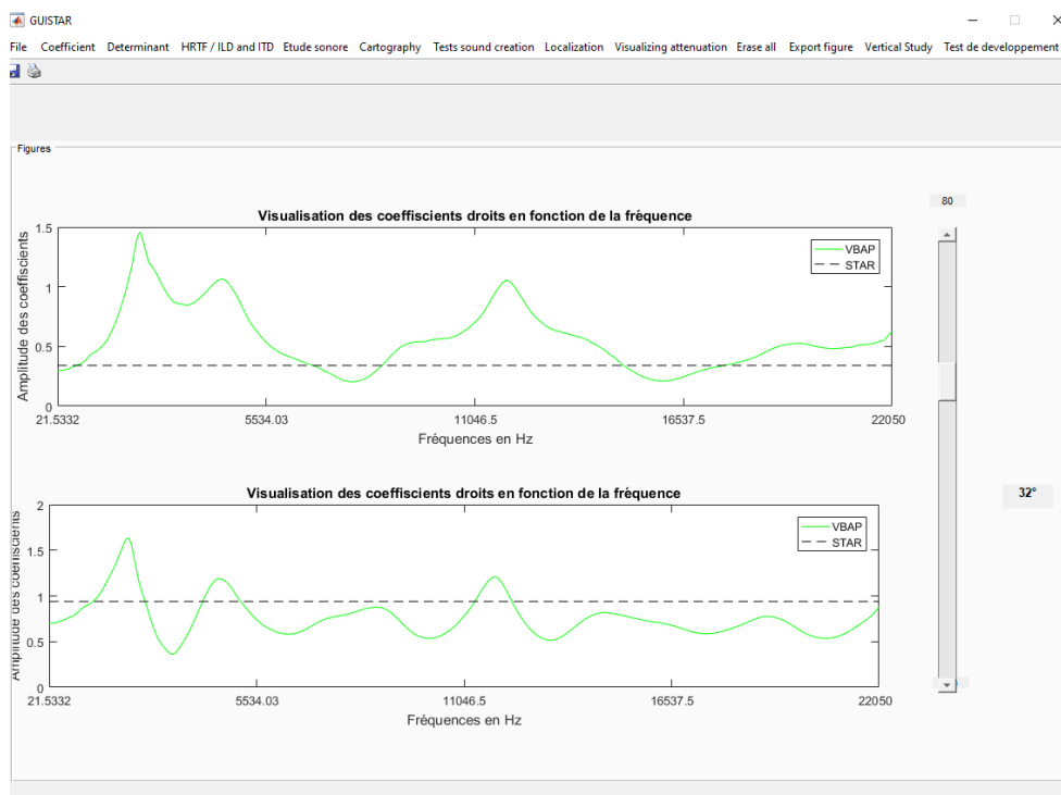
FIGURE 11.5 – Exemple de visualisation globale de l'interface GUI-STAR. Ici la comparaison des coefficients des méthodes STAR et VBAP en fonction de l'azimut modifiable via le slider sur le côté droit.
