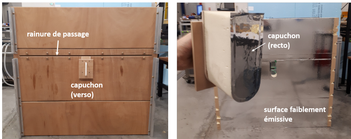
FIGURE 2.22 – Plafond de mesures des températures face extérieure (gauche) et intérieure (droite)
