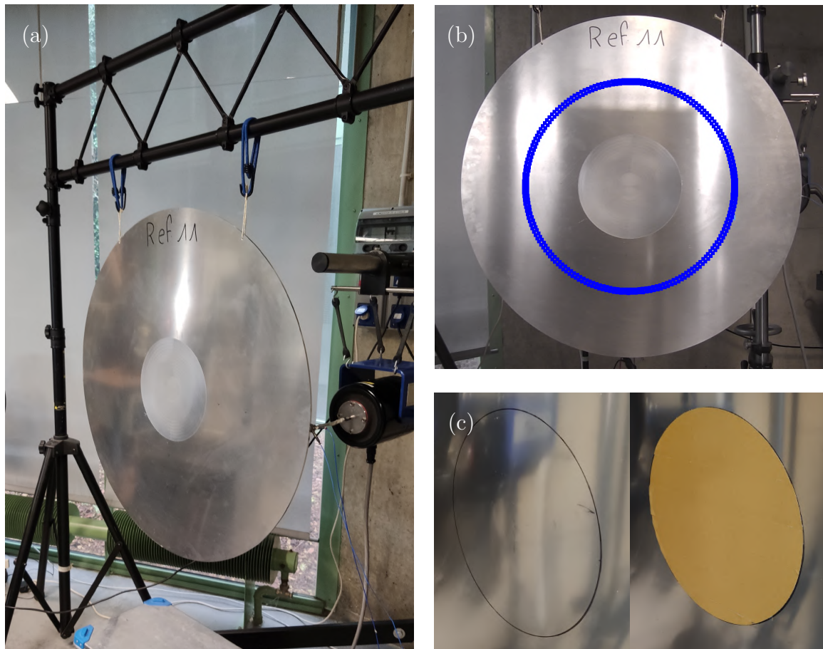
FIGURE 5.16 – (a) Photo du banc de mesure R_{2D}^0 . (b) Maillage de la couronne de mesure à travers le logiciel du Polytec PSV 500. (c) Photo de l'arrière d'un diffuseur sans et avec revêtement.
