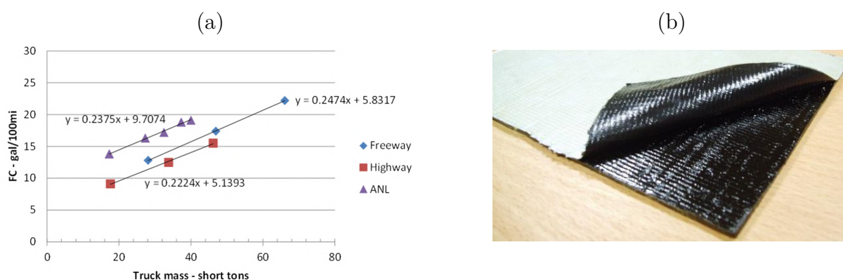
FIGURE 1.1 – (a) Consommation de carburant (FC, Fuel Consumption) en fonction de la masse d'un véhicule de transport terrestre lourd (Heavy Duty Class 8 Trucks) (d'après [1]). (b) Revêtement visco-élastique auto-adhésif utilisant pour la réduction des vibrations (société Acouphon).
