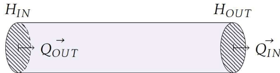
FIGURE 3.4 – Schéma d'une conduite forcée et notations.
