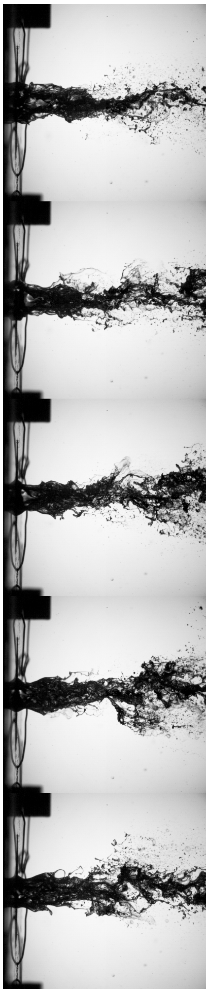
FIGURE III.7 – Évolution du jet liquide au cours du temps (de gauche à droite) pour de l'eau pure (haut) et du C_{12}TAB à 2.CMC (bas). Acquisition avec un un cadrage du jet plus proche que pour les images présentées en Figure III.6. L'écart temporel entre chaque image est de 0,6 ms. U_L=0,28 m/s, U_G=48 m/s.
