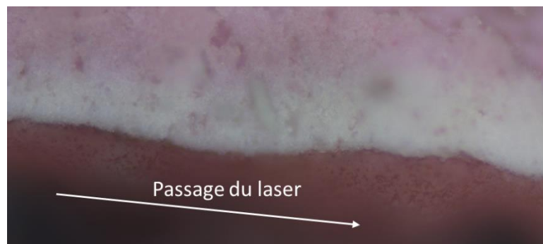
Figure 101 : Image de microscopie optique au bord du cordon irradié selon les paramètres : P = 40 \text{ W} , v = 75 \text{ mm/s} , e = 25 \mu\text{m} , h_s = 100 \mu\text{m}
