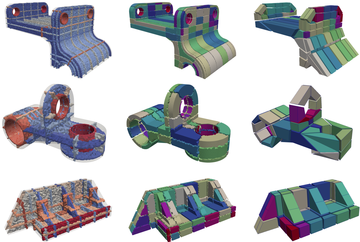
Figure 5.14 – Résultats pour les modèles M6, S24 et B79 avec, les feuillet duaux à gauche, les régions duales au centre et la structure de blocs à droite.
