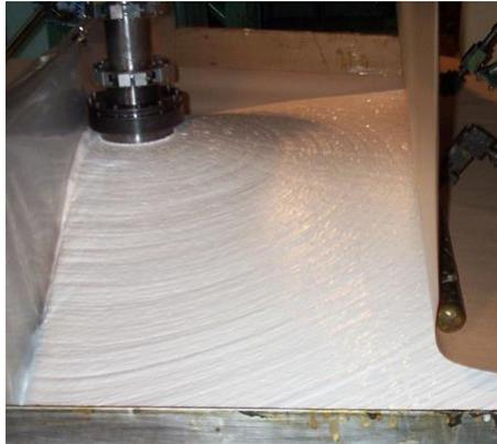
FIGURE 3.2 – Photographie de la buse de mélange des éléments chimiques utilisés pour la fabrication de la mousse.
