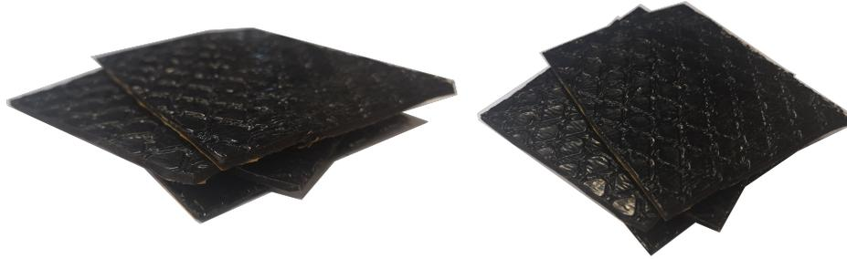
FIGURE 1.5 – Photographie d'un matériau viscoélastique de type Insonorisant Feuille Fusible (IFF).
