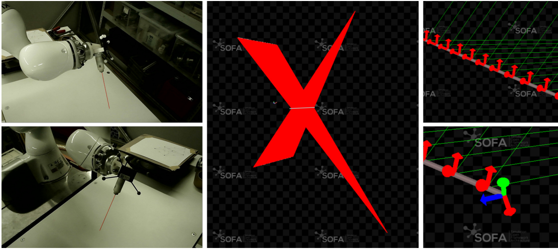
FIGURE 6.5 – Recalage de l'aiguille. À gauche, les images RGB de l'aiguille segmentées en rouge. Au centre, l'aiguille placée au croisement des lignes de projections des segmentations. À droite, les deux types de contraintes appliquées à l'aiguille.
