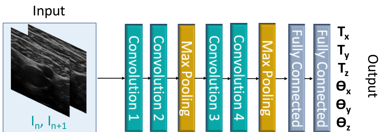
Figure 4.2 – Architecture du réseau pour l'estimation du déplacement entre deux images échographiques.
