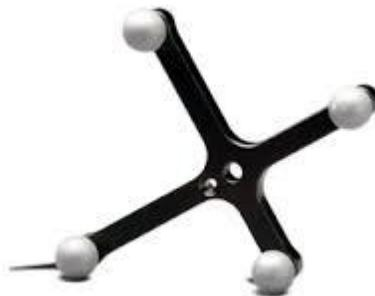
**Figure 3.2** – Marqueurs passifs utilisés avec le localisateur optique.
