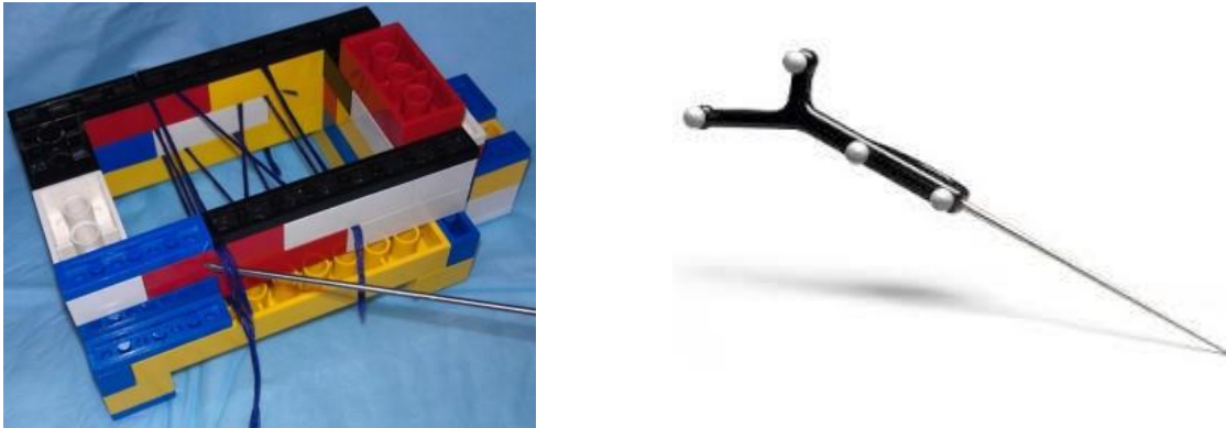
Figure 3.8 – Fantôme construit en briques LEGO (à gauche) et le pointeur avec ses marqueurs utilisé (à droite).
