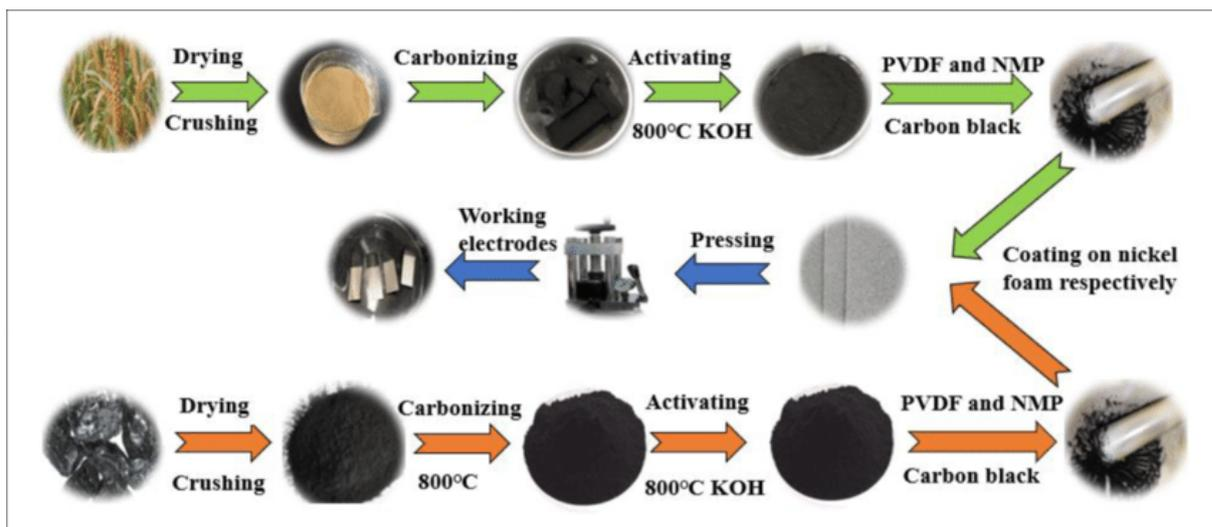
FIGURE 1.14 – Différentes étapes de préparation pour obtenir des électrodes de carbones activés issues de pailles de millet ou de charbon. Tiré de la référence [47].
